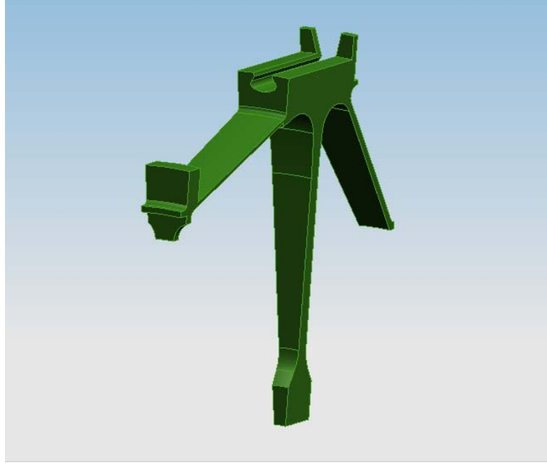
Şekil 4.4. Fan diski modelinin 48 eş parçasından bir tanesi (Unigraphics programında 7.5 derece ile silindirik koordinatlarda kesilmiştir)
