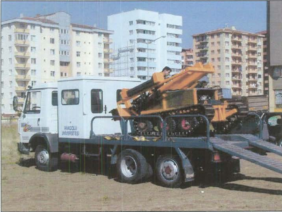
Şekil 4.6. Çalışmada kullanılan Sismik Konik Penetrasyon Test (SCPT) aleti
