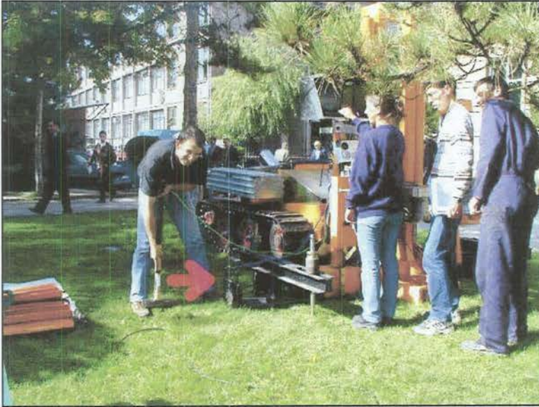
Şekil 4.13. SCPT aletinde sismik sinyalin oluşturulması
