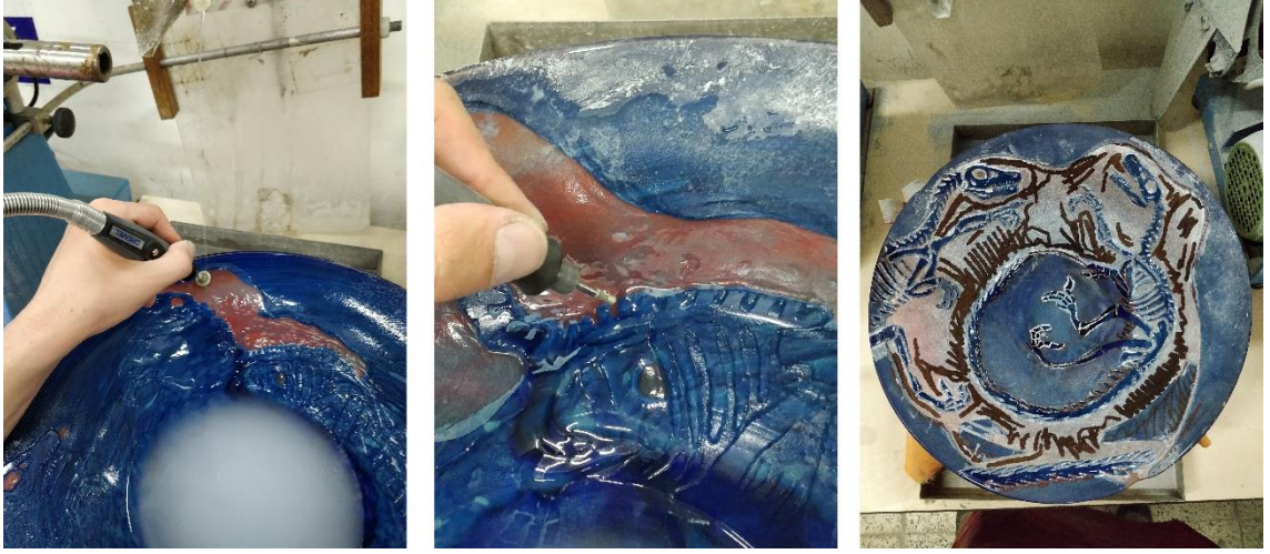
Görsel 3.12. Hareketli el motoruna takılabilen çeşitli boy ve şekillerdeki elmas uçlar, kazınacak bölgeye göre seçilir ve hem cam hem de uç suyla ıslatılarak, aralıklarla asetatlı kalemle de işaretlenerek kazıma işlemi gerçekleştirilir
