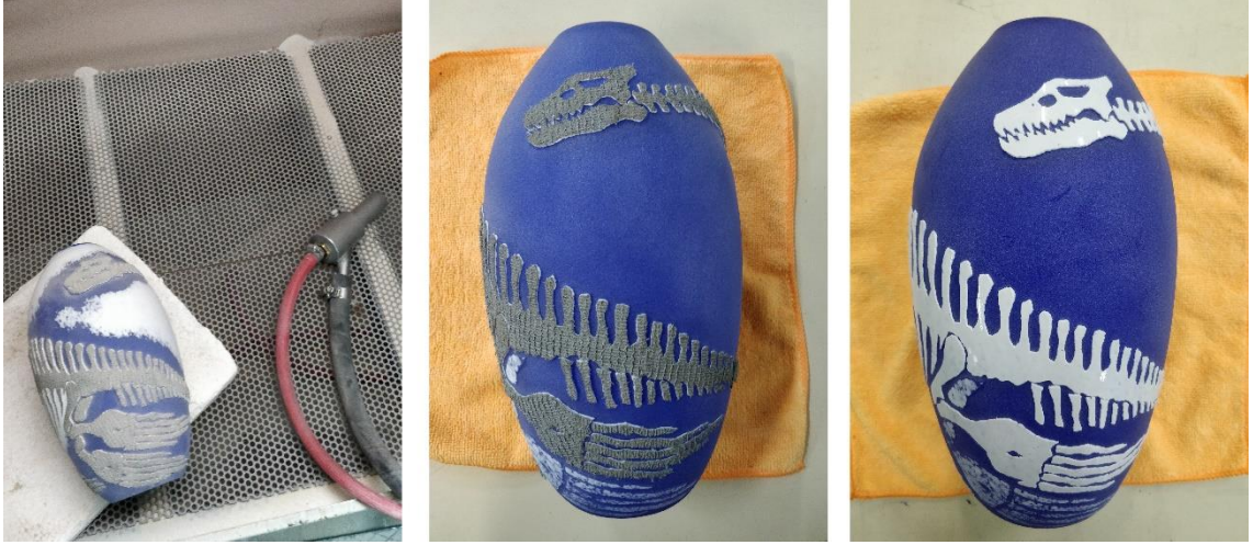
Görsel 3.11. İşlenmemiş obje üzerine kumlama yöntemi uygulanır ve işlem bittikten sonra tamir bandı çıkarılarak, cam temizlenir (Serkan Özer fotoğraf arşivi)
