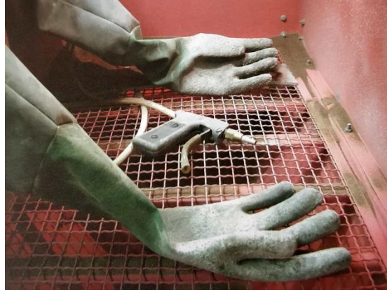
Görsel 2.51. Kumlama kabini içerisinde görüntü; eldiven ve kumlama tabancası (Schmuck, 2009, s. 86)
