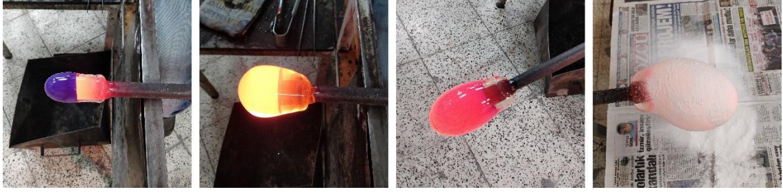
Görsel 3.2. Eritilen cam bar çubuk bir miktar üflenir ve üzerine tekrar cam sarılır. Ardından tekrar üflenerek ısıtılır ve sonra üzerine renkli toz cam eklenir
