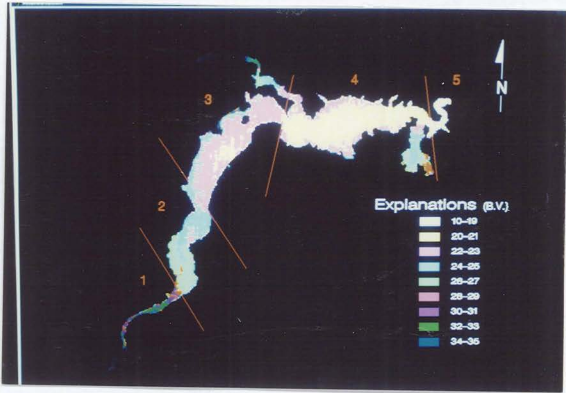
Şekil 5.7. Porsuk Baraj Gölü’nün, TM3 bant değerlerinin kullanılması sonucu oluşan kirlilik sınıflandırmasının görüntüsü
