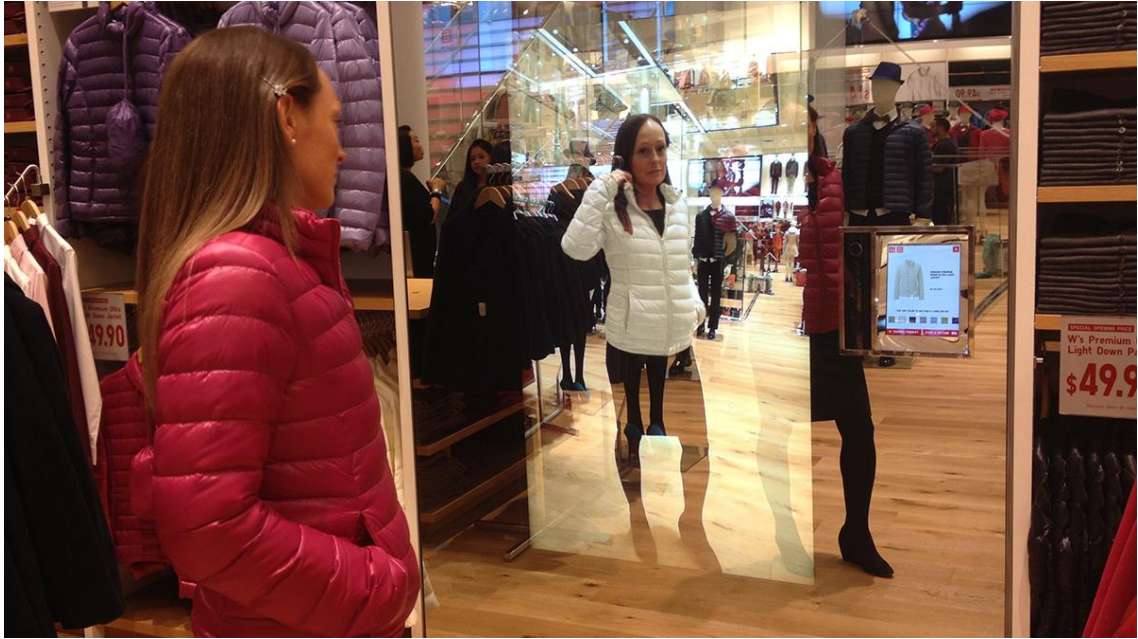
Görsel 2.9. Holiton firmasının tasarladığı Uniqlo Sihirli Ayna sistemi. Bu sistem kullanıcıların denediği giysileri değiştirmeden farklı renk kombinasyonlarını görmelerini sağlamaktadır. Yalnızca bu işlem için etkileşime girilebilir ( http-35 )
