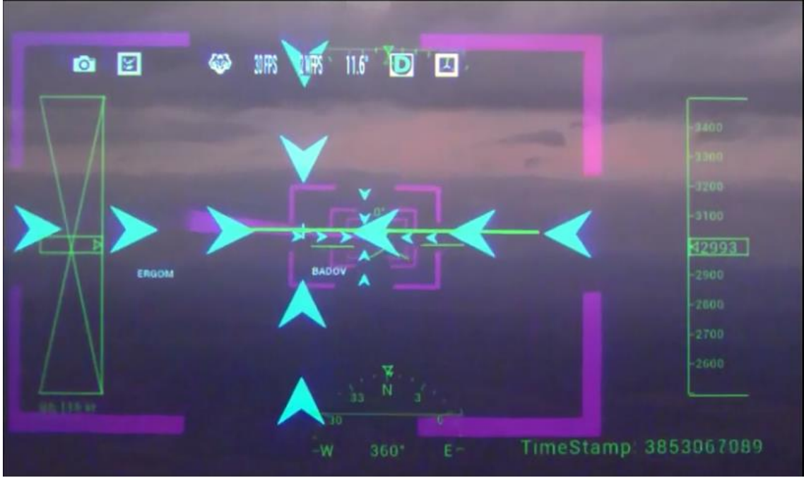
Görsel 3.6. Aeroglass şirketinin geliştirdiği akıllı gözlüklerin ekran görüntüsü. Mor köşeli çizgilerin betimlediği simetrik alanı göz kareye tamamlamaktadır ve bir bütün olarak görmektedir. Bu çizgiler ile uçağın uçuş rotası betimlenmektedir (http-45)
