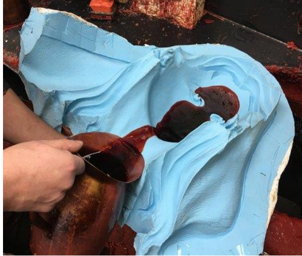
Görsel 2.16. Mumun Kalıp İçine Dökülme Aşaması ( https://www.baerbronze.com/wax-pour , Erişim tarihi: 23.02.2019)
