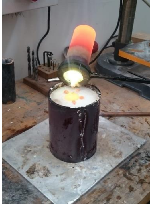
Görsel 2.29 Metalin Dereceye Dökülme Aşaması ( Ergün Arslan,2019)
