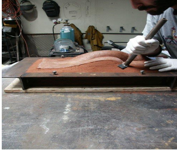
Görsel 2.6. Döküm Kumunun Sıkılaştırılma Aşaması ( https://www.instructables.com/id/Making-a-sand-cast-bronze-sculpture/#discuss , Erişim tarihi: 13.02.2019)
