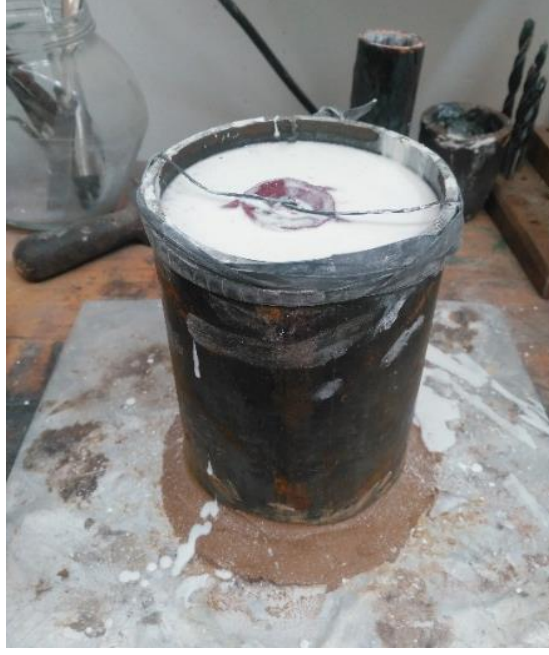
Görsel 2.27. Modelin Derece Kalıba Alınma Aşaması (Ergün Arslan,2019)
