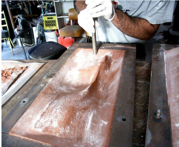
Görsel 2.10. Kalıp boşluğuna yolluk ve çıkıcıların açılması ( https://www.instructables.com/id/Making-a-sand-cast-bronze-sculpture/#discuss , Erişim tarihi: 17.02.2019)
