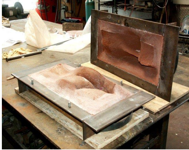
Görsel 2.12. Kalıbın Açılma Aşaması ( https://www.instructables.com/id/Making-a-sand-cast-bronze-sculpture/#discuss , Erişim tarihi: 17.02.2019)
