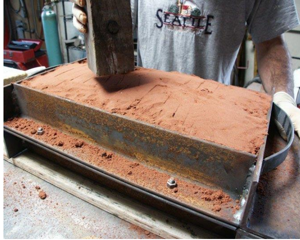
Görsel 2.8. Üst Kalıp Kasasına Kum Eklenerek Doldurulma Aşaması ( https://www.instructables.com/id/Making-a-sand-cast-bronze-sculpture/#discuss , Erişim tarihi: 15.02.2019)
