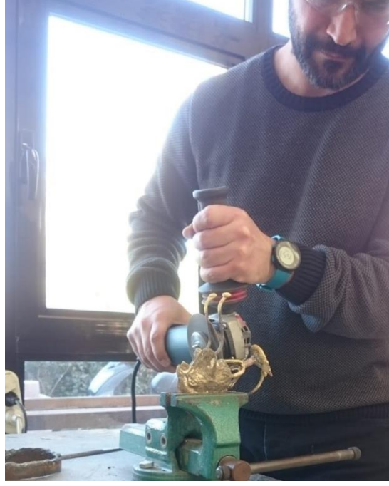
Görsel 2.31. Yolluklar ve Çıkıcıların Kesilmesi Aşaması (Ergün Arslan,2019)
