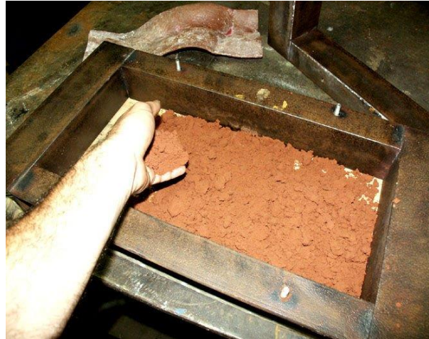
Görsel 2.4. Kalıp Kasasına Kum Ekleme Aşaması
