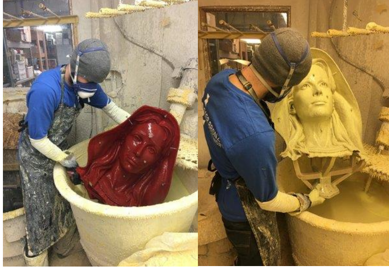
Görsel 2.24. Modelin Silika Tanakına Batırılması Ve Kaplanma Aşaması ( https://www.baerbronze.com/slurry , Erişim tarihi: 27.02.2019)
