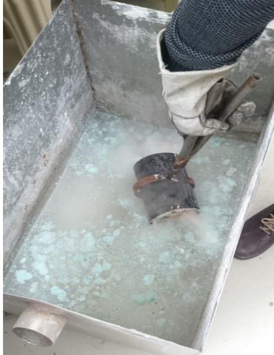
Görsel 2.30. Su Tankında Alçı Patlatma Aşaması (Ergün Arslan,2019)
