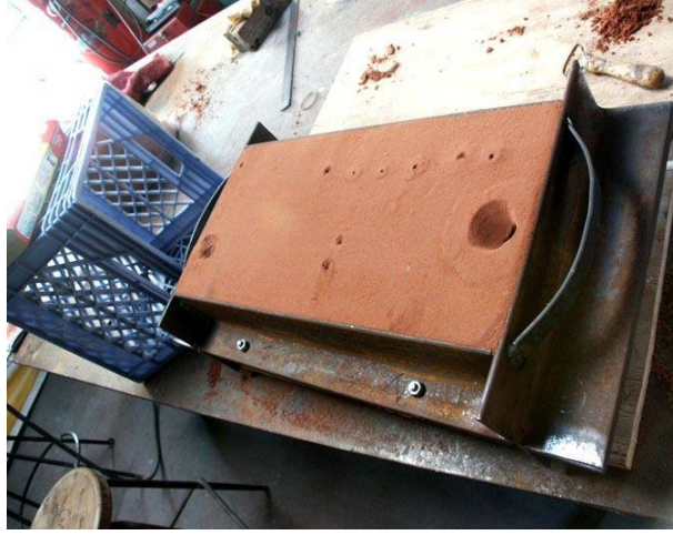
Görsel 2.11. Döküm Ağzı ve Gaz Yollarının Açılma Aşaması ( https://www.instructables.com/id/Making-a-sand-cast-bronze-sculpture/#discuss , Erişim tarihi: 17.02.2019)
