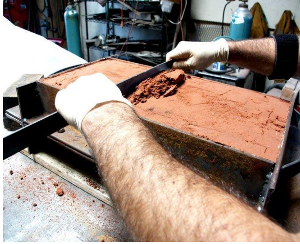
Görsel 2.9. Kumun Traşlanarak Düzeltme Aşaması ( https://www.instructables.com/id/Making-a-sand-cast-bronze-sculpture/#discuss , Erişim tarihi: 15.02.2019)
