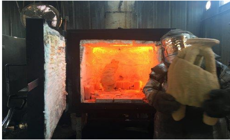
Görsel 2.25. Kaplama Sonrası Fırınlanma Aşaması ( https://www.baerbronze.com/slurry , Erişim tarihi: 27.02.2019)
