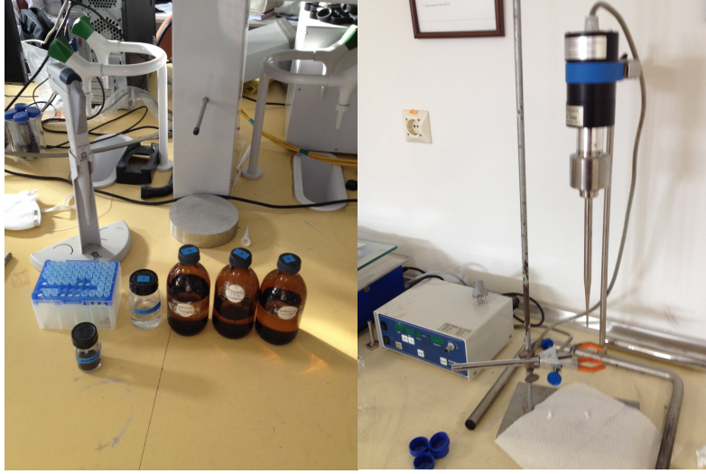
Şekil 4.4. Solda karışımın hazırlanması ve sağda ultrasonik karıştırıcı
