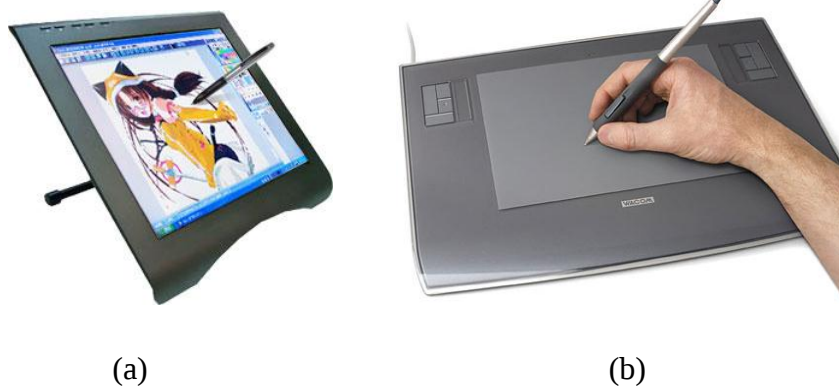
Şekil 4.16 Ekranlı ve ekransız grafik tablet
