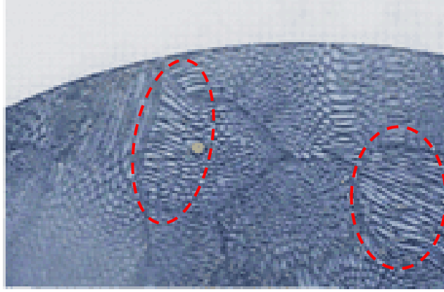
Şekil 1.3. Hücre-fiber yapıya sahip seramik kesici ucun fiber dağılımını gösteren optik mikroskop görüntüsü
