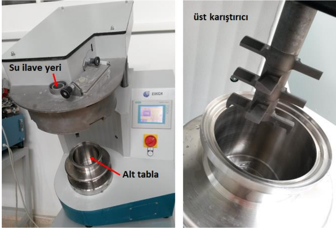
Şekil 1.38. Şiddetli karıştırıcı alt tabla ve üst karıştırıcı ile su ilave yerinin gösterimi
