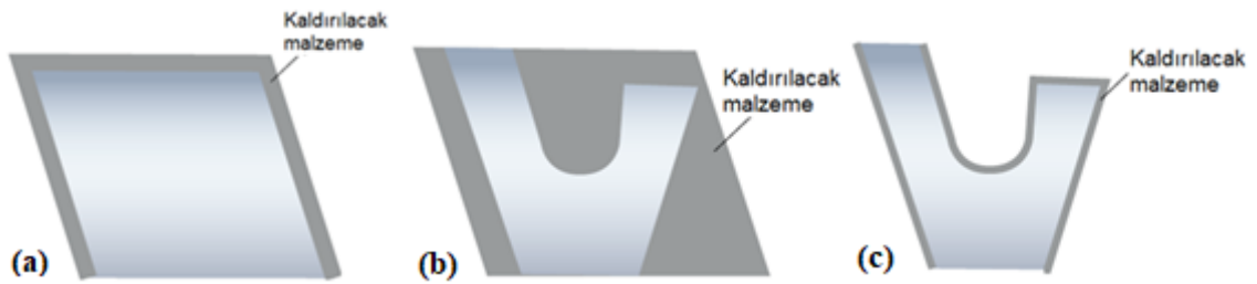
Şekil 1.7. Süperalaşımların işleme aşamalarında kaldırılan malzeme miktarının şematik gösterimi (a) kaba işleme, (b) ara işleme, (c) bitirme işleme [37]
