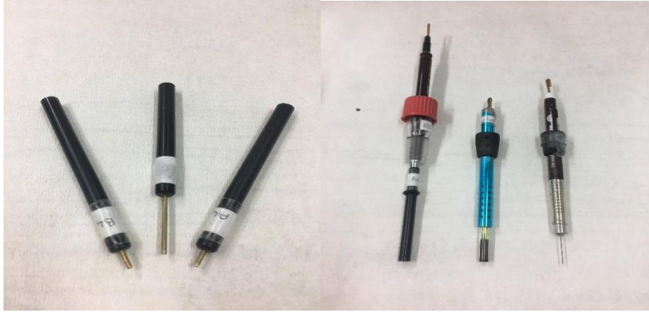
Şekil 2.3. Voltametrik ölçümlerde kullanılan çeşitli çalışma elektrotları
