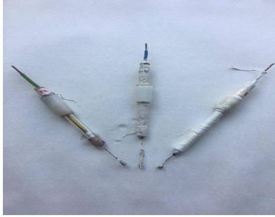
Şekil 2.4. Voltametrik ölçümlerde kullanılan platin uçlu karşıt elektrotlar
