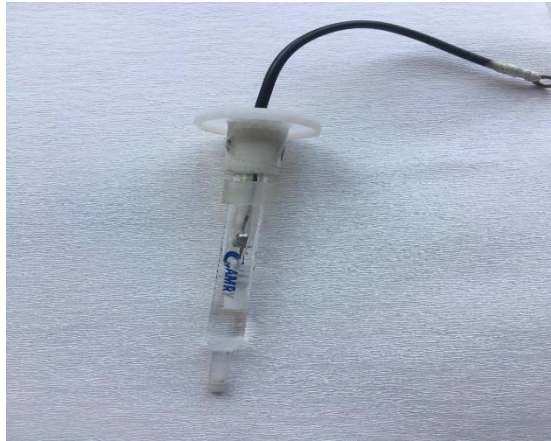
Şekil 2.5. Voltametrik ölçümlerde kullanılan kalomel referans elektrot
