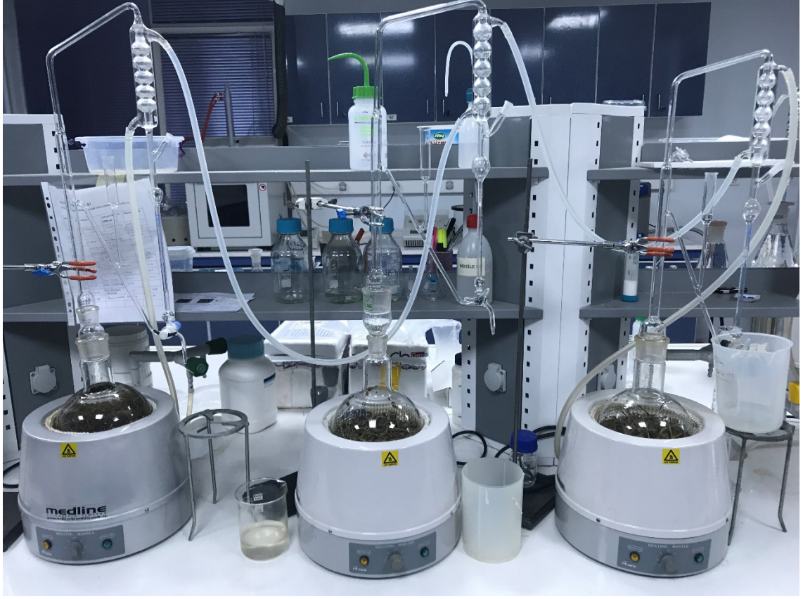
Görsel 3.6. Uçucu yağ eldesinde kullanılan Clevenger apareyi düzeneği
