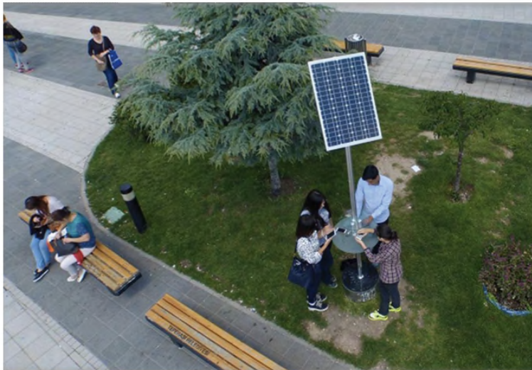
Görsel 5.10. Güneş Enerjili Cep Telefonu Şarj İstasyonu
