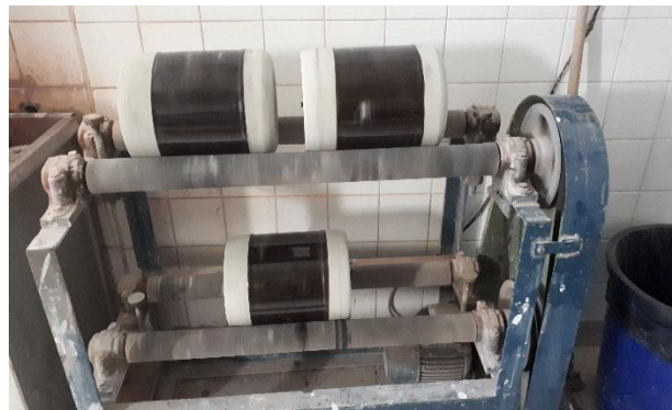
Görsel 4 .2. 1 kg üzerinden hazırlanan hammaddelerin bilyalı değirmende öğütülme aşaması
