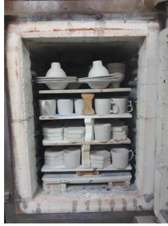
Görsel 4. 4. Hazırlanan sır deneme plakaları fırına doldurulmuştur
