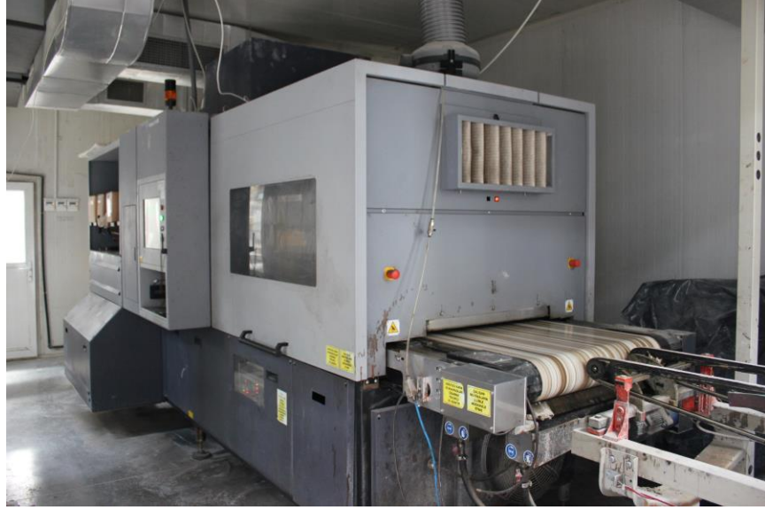
Görsel 5. 2. Ürünlerin basıldığı Durst HD dijital baskı makinesi Kaynak: Ziya Yekta Özkan Fabrika Fotoğrafları.2015
