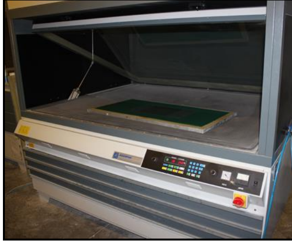
Görsel 2. 5. Etüvlü (kurutmalı) elek pozlama kabini Kaynak: Ziya Yekta Özkan Fabrika Fotoğrafları.2015
