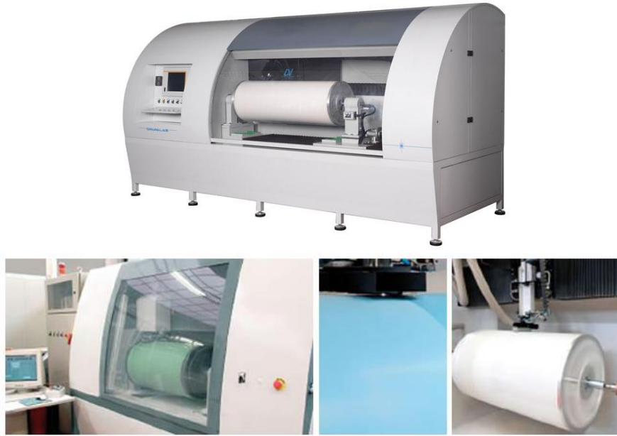
Görsel 2. 17. Farklı tip ve özelliklerde rotatif eleğe desen işleyebilen lazer işleme makinesi
