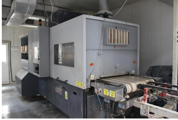
Grsel 3. 6. retim bantında kurulu dijital baskı makinesi Kaynak: Ziya Yekta zkan Fabrika Fotoğrafları.2015
