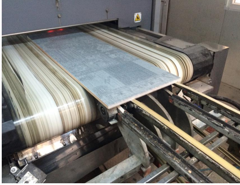
Görsel 5. 51. Üretim bantında klasik dekor deseninin karo üzerine basımından sonra karonun makineden çıkışı
