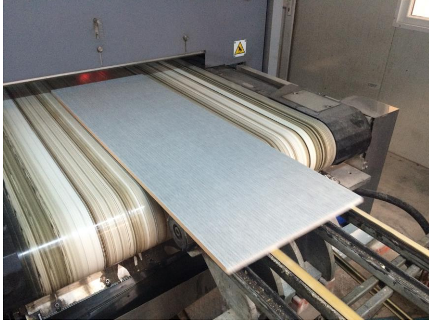
Görsel 5. 50. Üretim bantında desenin karo üzerine basımından sonra karonun makineden çıkışı Kaynak: Ziya Yekta Özkan Fabrika Fotoğrafları.2015
