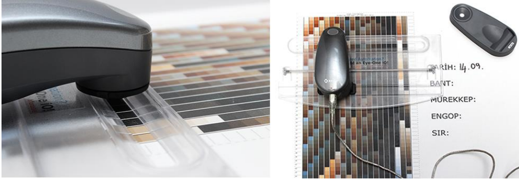
Görsel 4. 17. Manuel spektrafotometre ile renk kutucuklarının okunması
