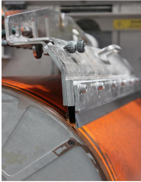
Görsel 2. 18. Rotocolor elekte, baskı makinesinde bıçağın elek yüzeyindeki konumu Kaynak: Ziya Yekta Özkan Fabrika Fotoğrafları.2015
