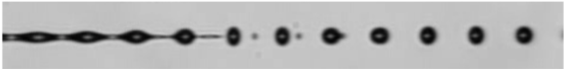
Görsel 2. 25. Jet adı verilen akışkan mürekkebin damlacık hale dönüşümü
