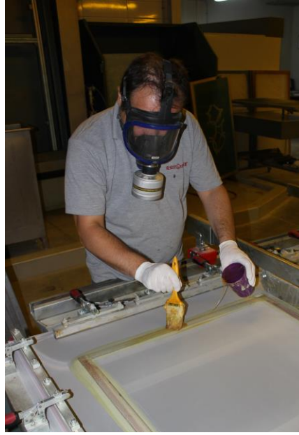
Görsel 2. 12. Gerdirilmiş elek bezinin çerçeve üzerine yapıştırılması
