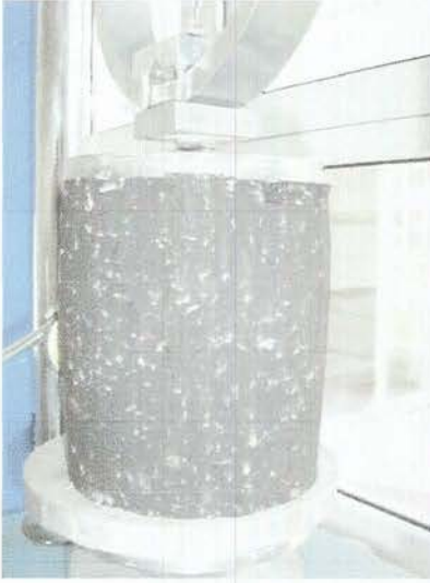
Şekil 6.3. Kalıp Kumu Numunesi Üzerinde Serbest Basınç Deneyi
