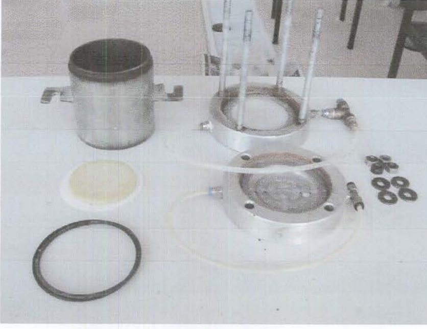
Şekil 6.5. Rijit Duvarlı Permeabilite Deneyinde Kullanılan Malzemeler
