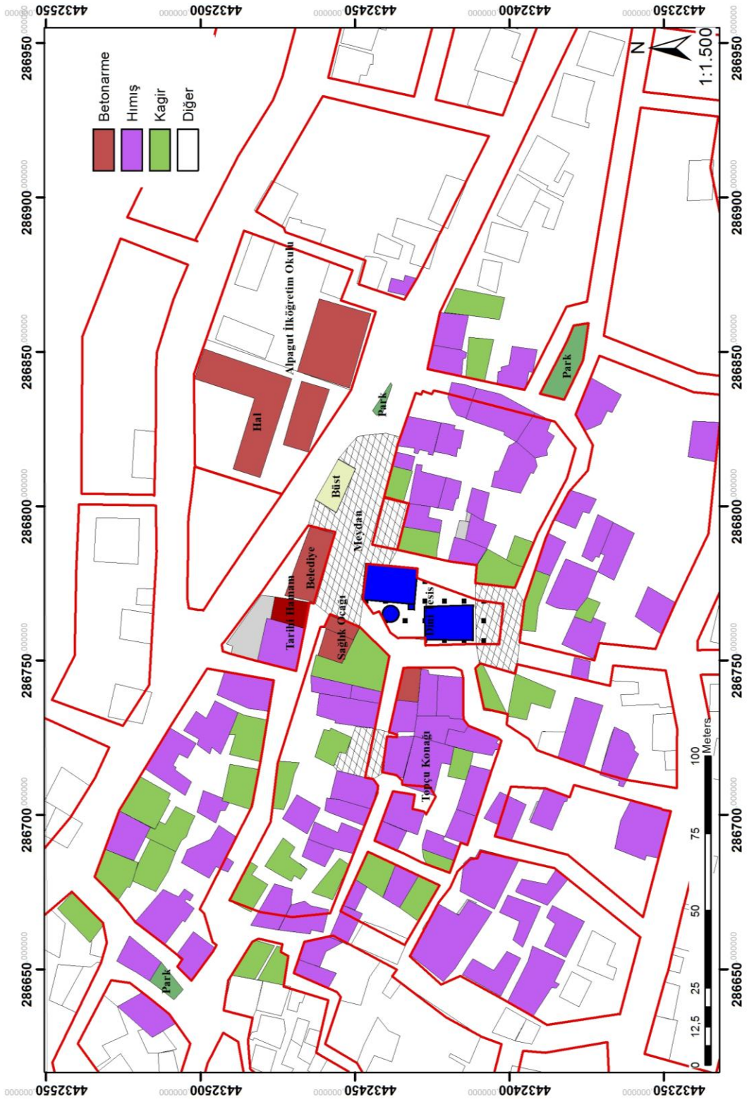
Şekil 4.9. Çalışma alanı yapılarında kullanılan duvar elemanlarının ana yapı malzeme çeşitliliği
