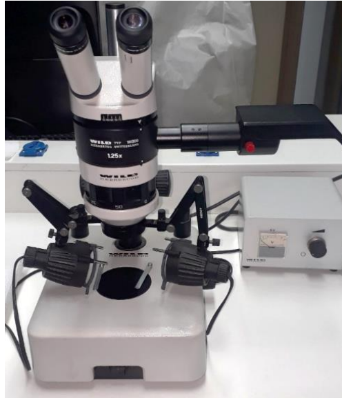
Şekil 3.4. WILD TYP 181300 stereo mikroskobu
