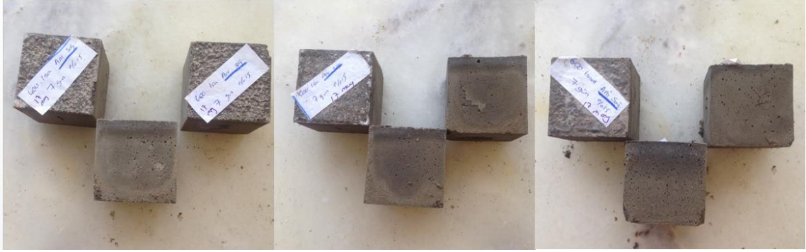
Görsel 3. 2. %15-FS-1s harç numuneleri (soldan sağa: %15-400-AS-1s, %15-500-AS-1s ve %15-600-AS-1s)
