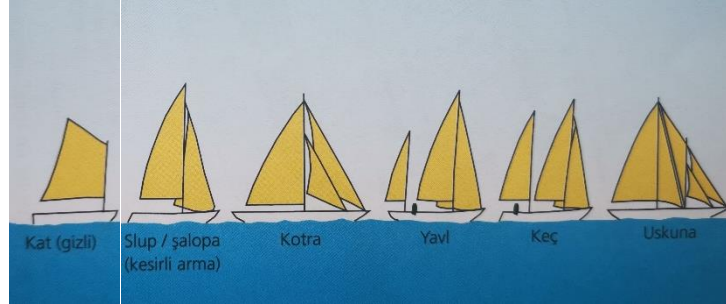
Görsel 3.8. Armalarına göre yelkenli örnekleri. Kaynak: Atmaca, 2013, s. 29
