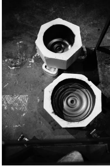
Görsel 4.6. Sıcak Cam Üfleme Kalıplar/Fotoğraf: Serhat Özdemir
