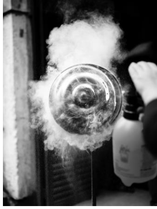
Görsel 4.19. Püskürtme Yöntemiyle İridesan Etki Uygulaması/ Fotoğraf: Serhat Özdemir
