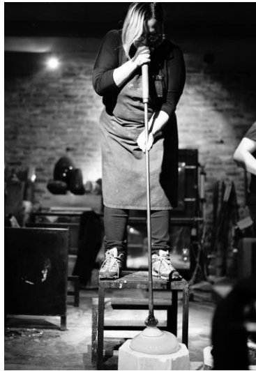
Görsel 4.16. Kalıba Üfleme Aşaması/ Fotoğraf: Serhat Özdemir
