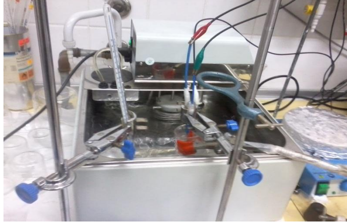
Şekil 3.4. CV ve EIS ölçümlerinin yapıldığı sıcaklık kontrollü deney düzeneği
