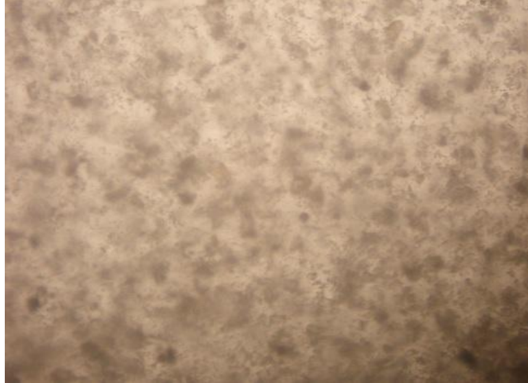
Şekil 6.2. Kütlece % 6 fumed silika ile 1:1 oranında hazırlanan \text{SiO}_2:\text{Al}_2\text{O}_3 elektrolit sistemine ait a) jelleşme öncesi ve b) jelleşme sonrası 10x büyütme görüntüleri
