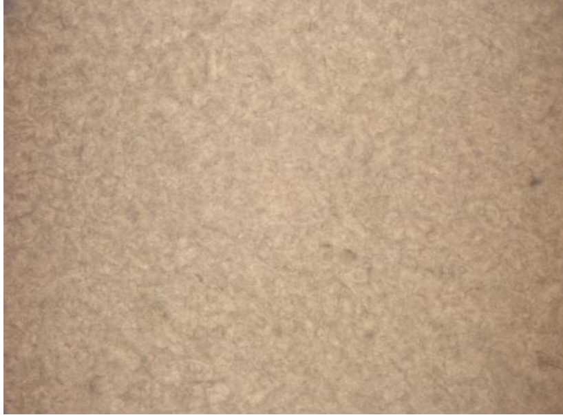
Şekil 6.9. Kütlece % 6 fumed silika karışımına 0,25 g MgSO_4 eklenerek hazırlanan elektrolit sistemine ait a) jelleşme öncesi ve b) jelleşme sonrası 10x büyütme görüntüleri
