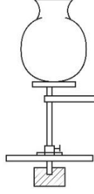
Görsel 2.15. Anadolu'da kullanılan çömlekçi torna tipleri (e)
