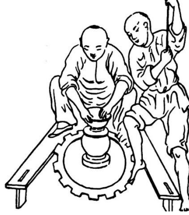
Görsel 2.6. Güney Çinde 19.yüzyılda kullanılan makara sistemli çömlekçi tornası
