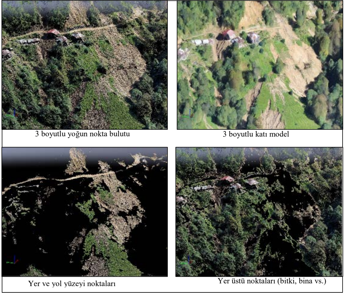
Şekil 4.4. Veri işleme aşamasında üretilen yoğun nokta bulutu verisi, 3 boyutlu katı model, nokta bulutunun sınıflandırılması sonucu elde edilen yer ve yol yüzeyi noktaları ile yer üstü noktaları
