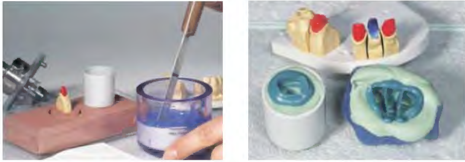
Şekil 4.6. Dublikasyon malzemesinin hazırlanması [109]
