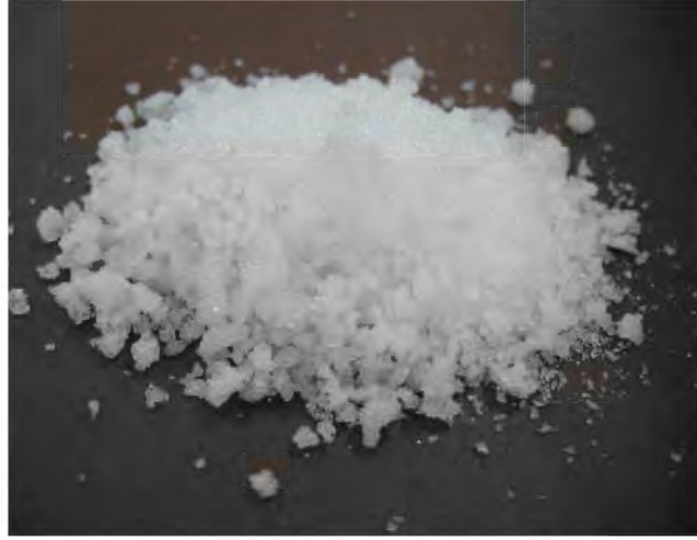
Şekil 7.3. Üretilen B kodlu diş porseleni friti
