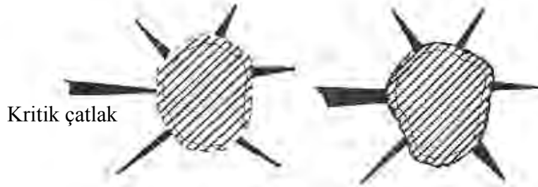
Şekil 5.5. Tetragonal-monoklinik faz dönüşümü sonucu zirkonya tanelerinin etrafında mikro çatlak oluşumu [141]
