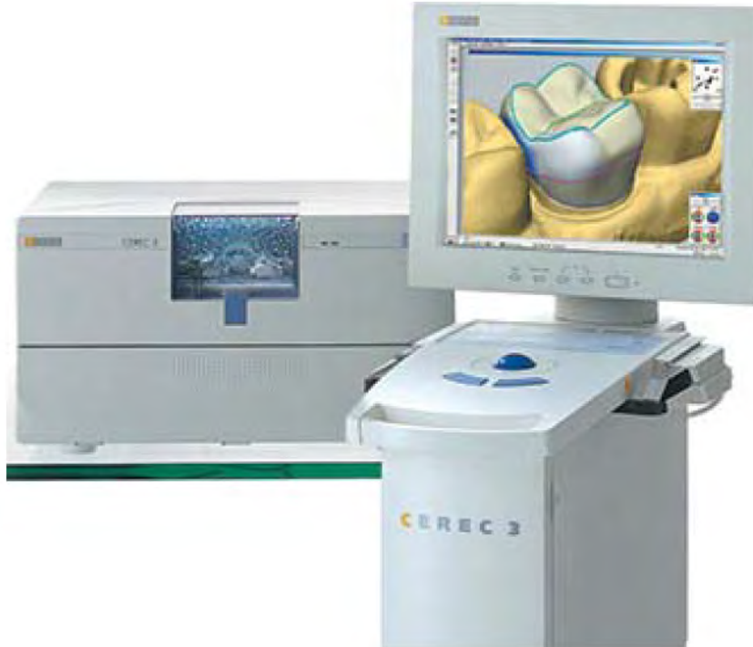
Şekil 4.21. Vita Cad-Cam sistemi ve modelajın bilgisayar ortamındaki görüntüsü [126]
