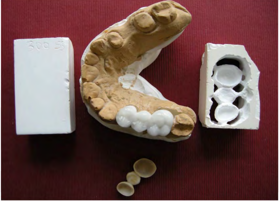
Şekil 11.1. Çalışmada üretilen zirkonya blok, bloğun işlenmesiyle elde edilen renklendirilmiş ve sinterlenmiş zirkonya destek ve destek üzerine porselen tabakalarının uygulanması sonucu elde edilen nihai ürünün görüntüsü
