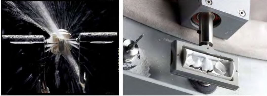
Şekil 4.25. Bloğun otomatik cihazda işlenmesi [132, 133]
