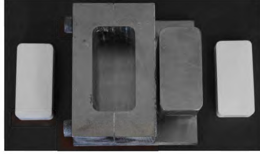
Şekil 7.1. 35x76 mm ebatlarında el presi kalıbı ve şekillendirilen numuneler
