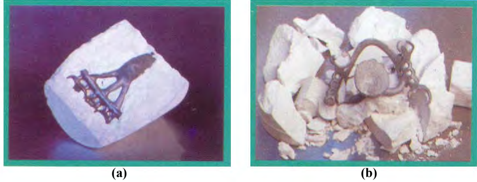
Şekil 3.7. Metalin santrifüj yoluyla dökümü (a) ve manşetin açılması (b) [41]
