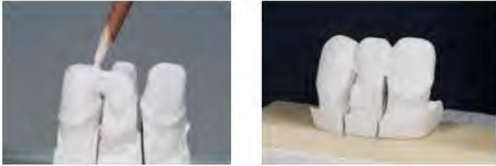
Şekil 4.9. Hazırlanan çamurunun alçı kalıp üzerine uygulanması [109]
