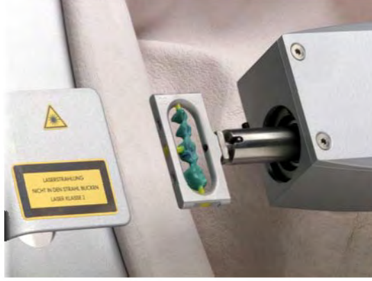
Şekil 4.20. Mum modelajın cihaza okutulması [125]
