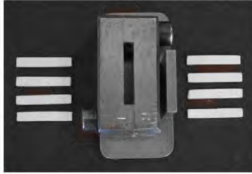
Şekil 7.13. Üç nokta eğme test numunelerinin hazırlanmasında kullanılan kalıp ve elde edilen numuneler
