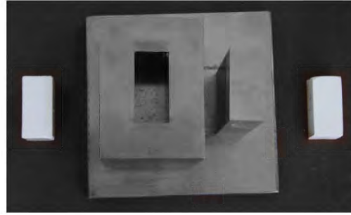
Şekil 7.2. 19x40 mm ebatlarında el presi kalıbı ve şekillendirilen numuneler
