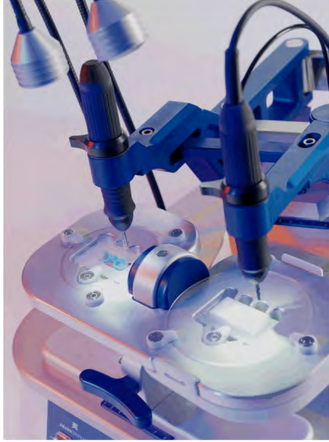
Şekil 4.22. Manüel cihaza yerleştirilmiş modelaj ve zirkonya blok [127]
