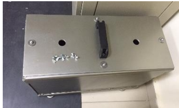
Görsel 4.3. TÜBİTAK MAM Batarya güvenlik ve test kabini
