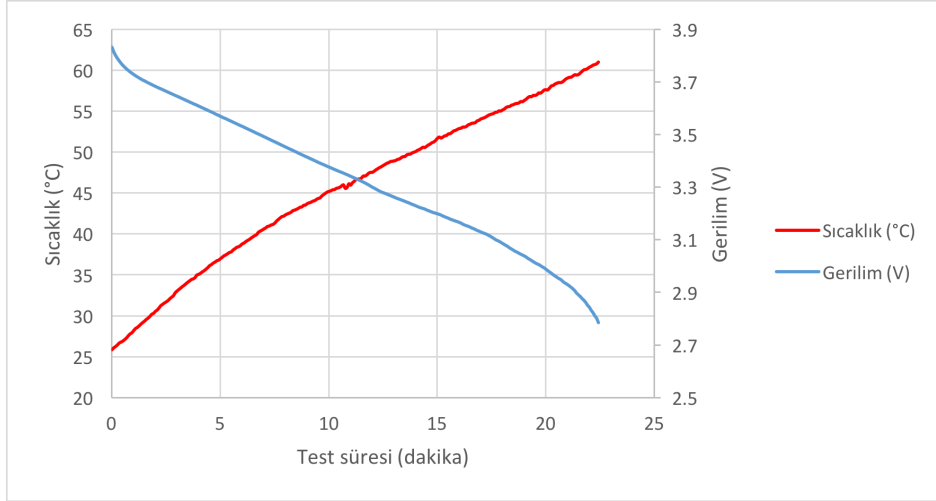
Şekil 6.23. Üretici B hücresi 2.5C deşarjı
