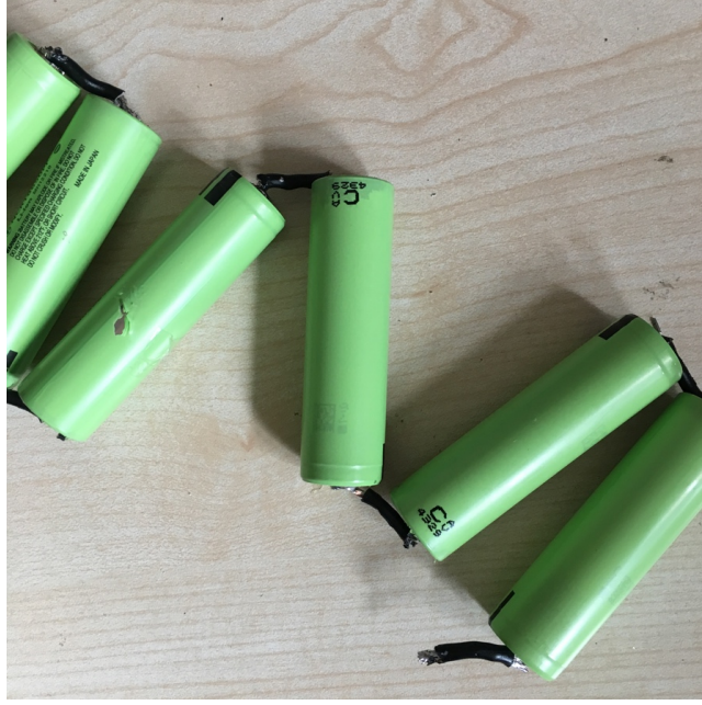
Görsel 6.4. Seri bağlı 6 hücreden oluşan batarya
