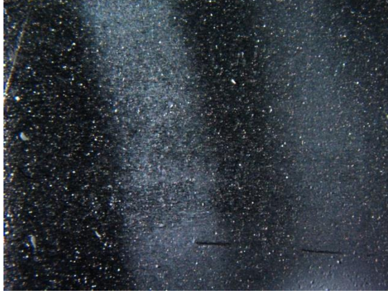
Şekil 6.18. HAP-k ile kumlanmış Titanyum plaka üzerine 3 mm mesafeden yapılan kaplama sonrası çekilen 11x büyütmede optik mikroskop görüntüsü (15000 cm 3 /dak gaz akış hızı)
