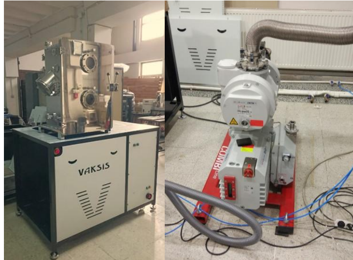
Şekil 5.6. Kaplama çalışmasının yapıldığı Aerosol Kaplama haznesi ve vakum pompaları
