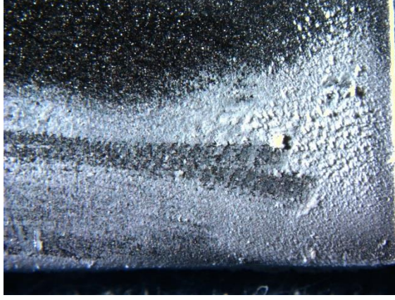
Şekil 6.16. HAP-s ile kumlanmamış Titanyum plaka üzerine 3 mm mesafeden yapılan kaplama sonrası 11x büyütmede çekilen optik mikroskop görüntüsü (15000 cm 3 /dak gaz akış hızı)
