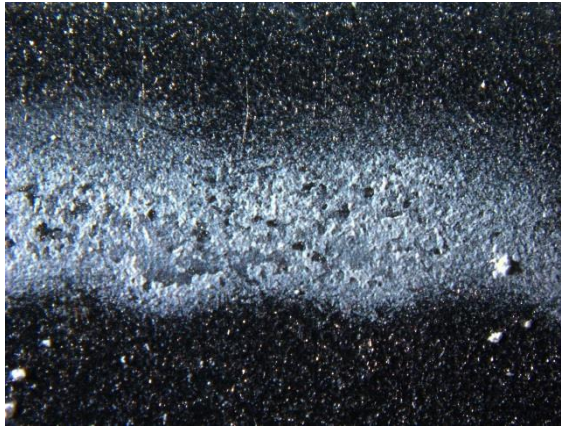
Şekil 6.17. HAP-s ile kumlanmış Titanyum plaka üzerine 3 mm mesafeden yapılan kaplama sonrası 11x büyütmede çekilen optik mikroskop görüntüsü (15000 cm 3 /dak gaz akış hızı)
