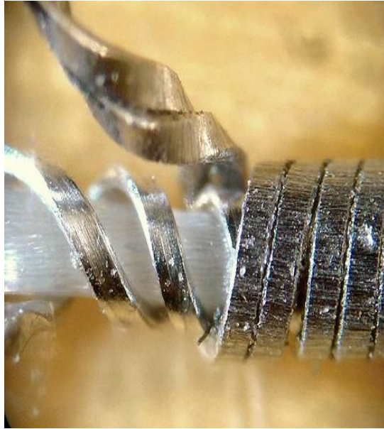
Görsel 1.6. Perlon üzeri alüminyum sargı
