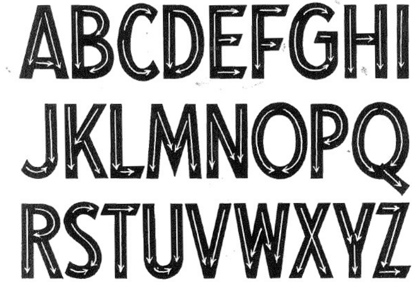
Görsel 2.25. Sans serif büyük harflerin çiziminde kullanılan konstrüktif vuruşların hareket yönleri (Matthews, 1958, s. 118)
