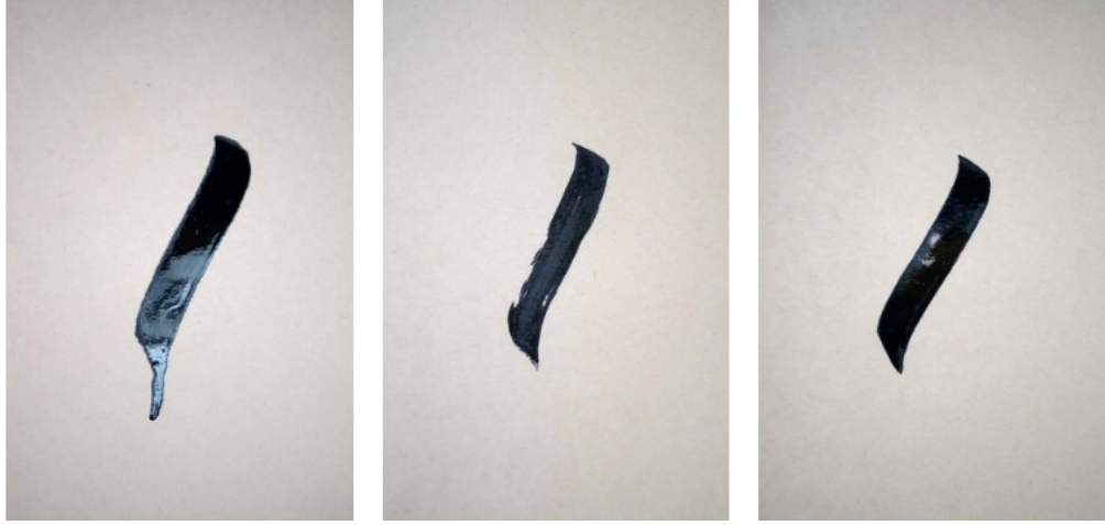
Görsel 2.74. Solda boyanın fazla inceltilmesi, ortada boyanın az inceltilmesi, sağda boyanın uygun miktarda inceltilmesinin fırça darbelerine etkisi ( http-33 )
