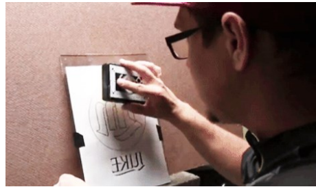
Görsel 2.50. Tebeşir pedi uygulaması ile tasarımın uygulama yüzeyine aktarılması ( http-15 )
