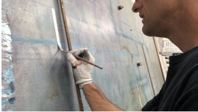
Görsel 2.72. Tabelacı ıstakası yardımı ile düz çizgi çizilmesi ( http-35 )
