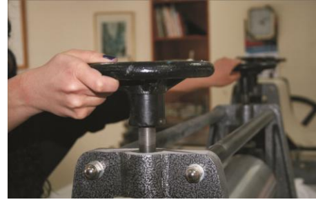
Resim 33, Baskı iřleminden önce presin ayarlanması
