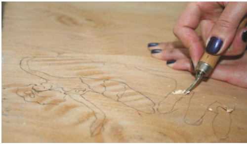
Resim 24, Oyulacak alan için uygun bıçağın kullanımı
