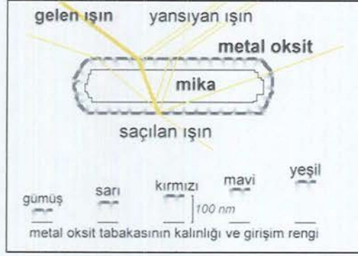
Şekil 4.4. Pigment tanelerinde girişim etkisinin oluşması [20]
