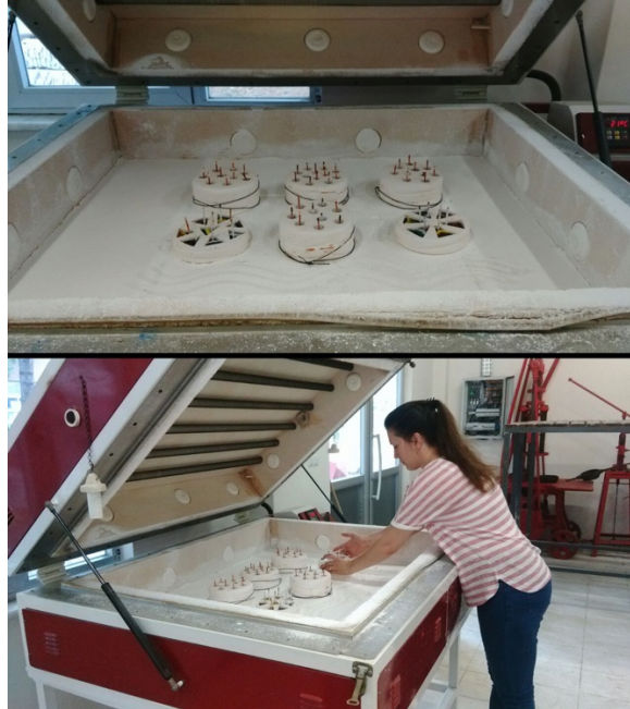
Görsel 4.8. Kalıpların Fırına Yerleştirilmesi Kaynak: Serap Bedel Özek (11.07.2016)
