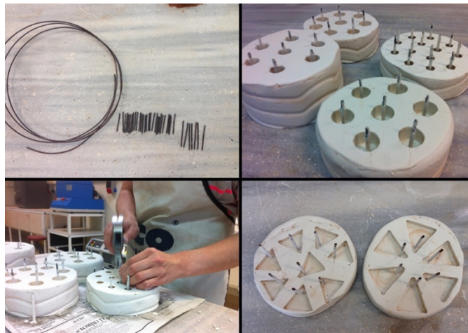
Görsel 4.3. Kesilen Demir Çubukların Kalıplara Yerleştirilmesi Kaynak: Serap Bedel Özek (24.06.2016)
