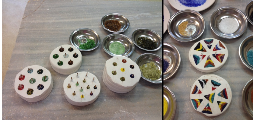
Görsel 4.7. Renkli Cam Kırıklarıyla ve Renkli Granül Camlarla Doldurulan Kalıplar Kaynak: Serap Bedel Özek (28.06.2016)
