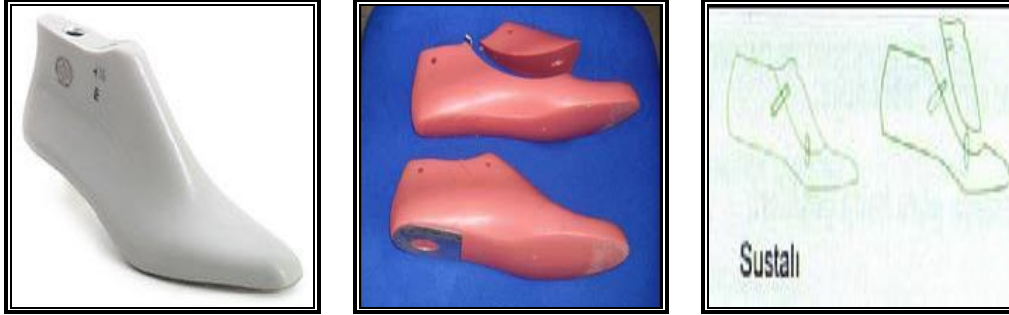
Resim 3.4. Çalışma Sistemine Göre Kalıplar (Soldan sağa düz, künyeli, sustalı) (Anonim, 2007a)
