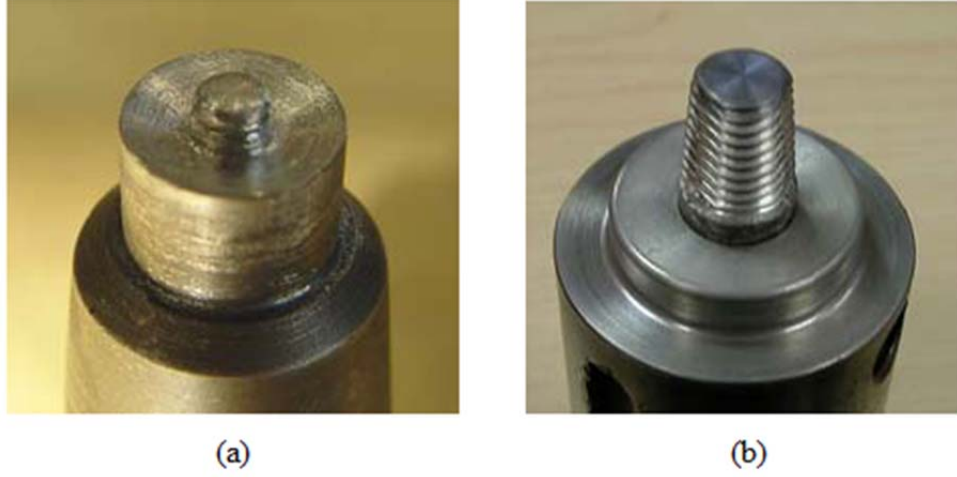
Şekil 3.9. (a) Silindirik kısmi dişli uç, (b) Konik dişli uç [31]
