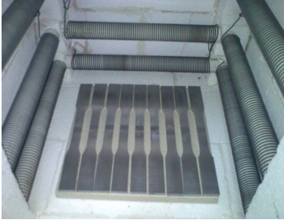
Şekil 5.12.a Isıl işlem Fırını (Çözelti ısıl işlemi için 550°C'ye ısıtılmış durumda)
