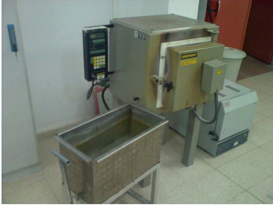
Şekil 5.12.b Numunelerin 550°C'deki fırından 6 saat sonra çıkartılması
