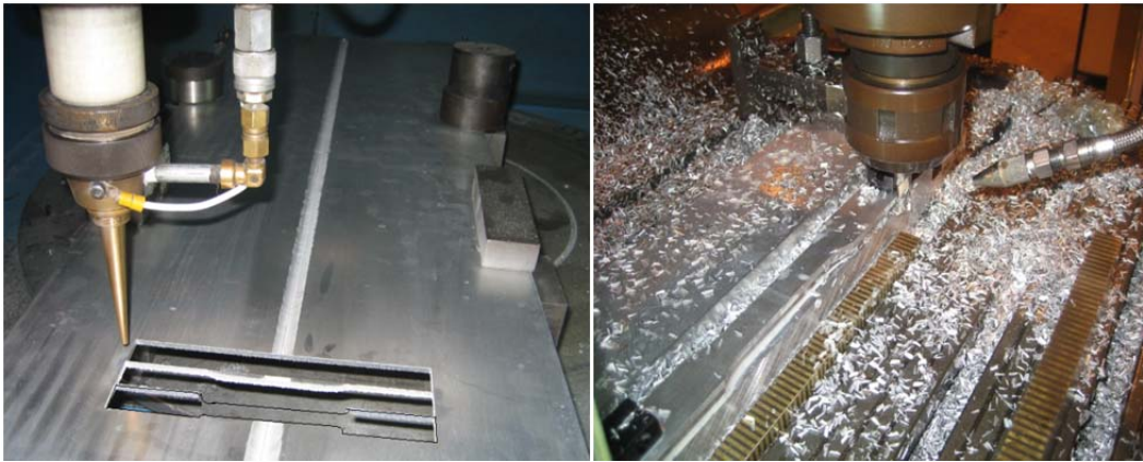
Şekil 5.4.b. Çekme ve yorulma numunelerinin lazerle kesilmesi ve frezede işlenerek hazırlanması
