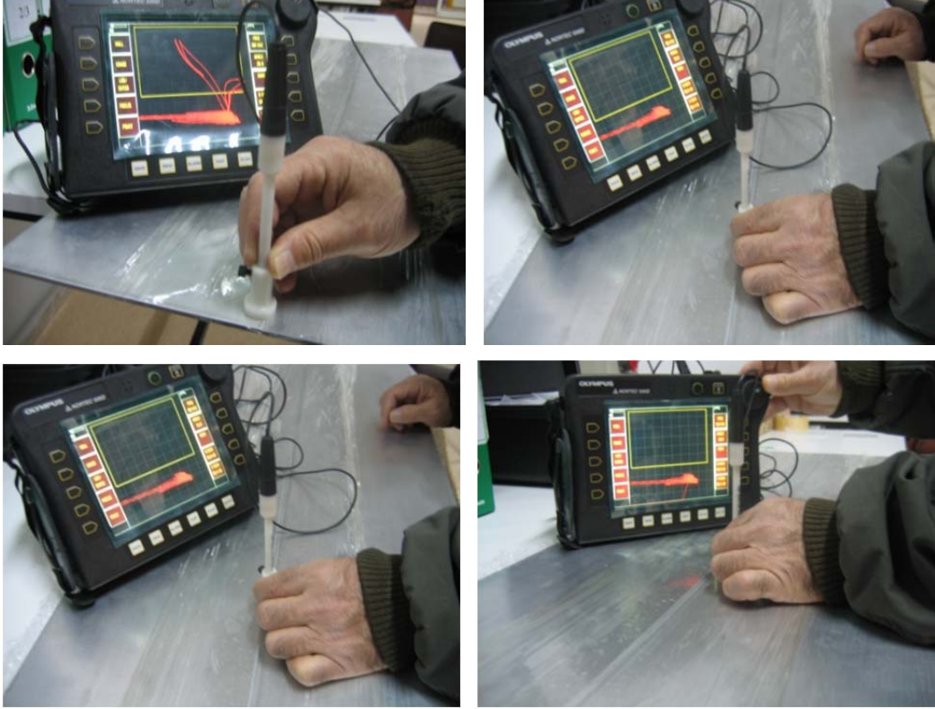
Şekil 5.10. Kaynaklı levhaya girdap akımları kontrol yönteminin uygulanması
