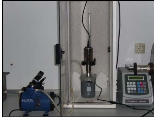
Şekil 6.19. Sonofotokatalitik oksidasyon reaktörü
