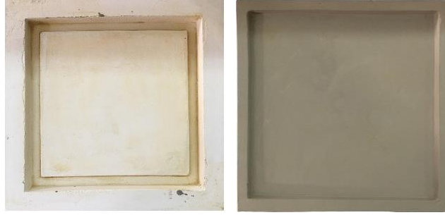
Görsel 4.1. Kare Formun Kalıbı ve Kalıptan Çıkarılan Ürün (Öztürk Razi,2018)
