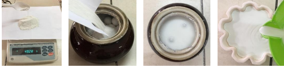
Görsel 3.6. Sırın Tartılması, Öğütülmesi ve Uygulama Aşamaları (Öztürk Razi,2018)
