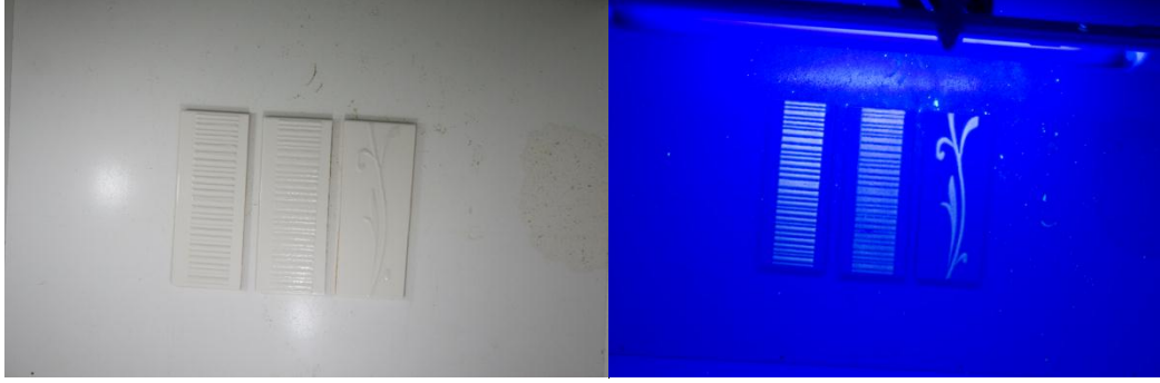
Şekil 2.26. Beyaz bölgede ışıldama yapan pigmentlerin kullanıldığı seramik çalışmalara ait aydınlık ve karanlık ortam görüntüleri (Morötesi ışık ile uyarma)
