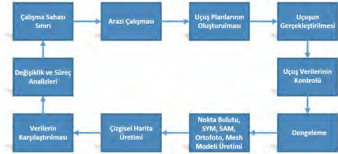
Şekil 3.10. Uygulanan yöntemler akış diagramı
