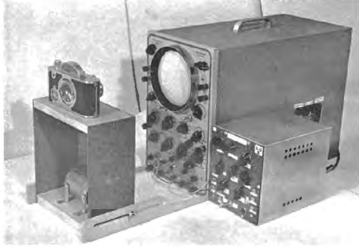
Görsel 1.8. Sinüs dalga jeneratörü ve fotoğraf düzeni ile değiştirilmiş osiloskop (Laposky, 1969, s.346)
