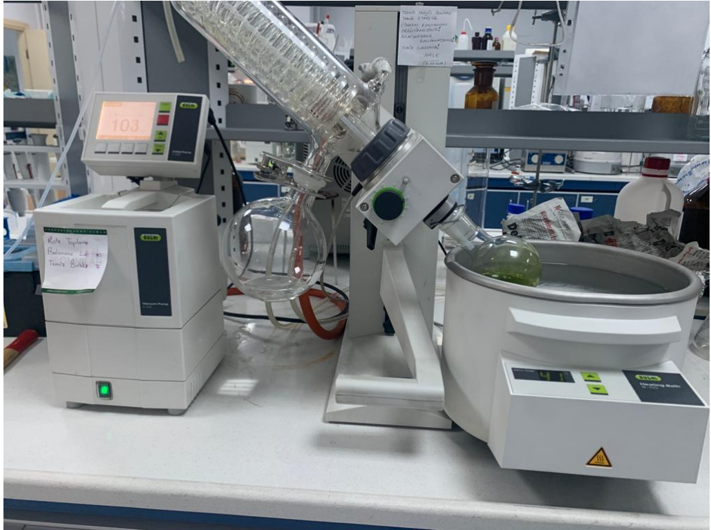
Görsel 3.3. Rotary Evaporator/Rotavapor cihazı (BUCHI, Switzerland)
