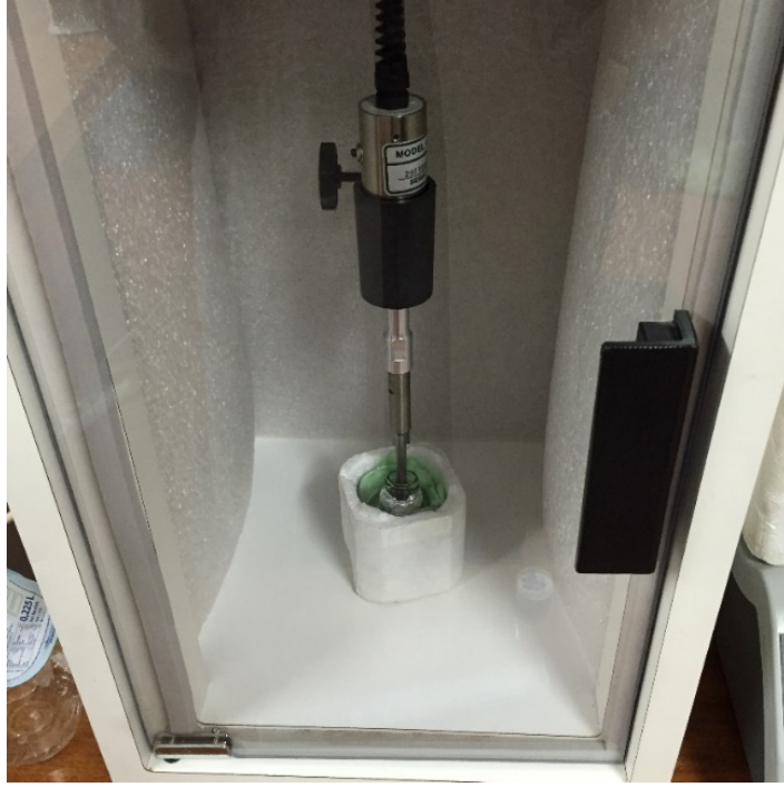
Görsel 4.3. Prob Sonikasyon Cihazı ile Formülasyon Hazırlanması
