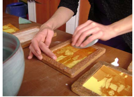
Resim 53. Sudan alınan laklı desenin seramik bünye üzerine yerleştirilmesi ve fil kulağı yardımıyla havasının alınması
