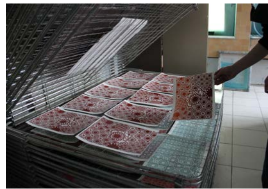
Resim 51. Çıkartma kağıdına serigrafi uygulama aşaması
