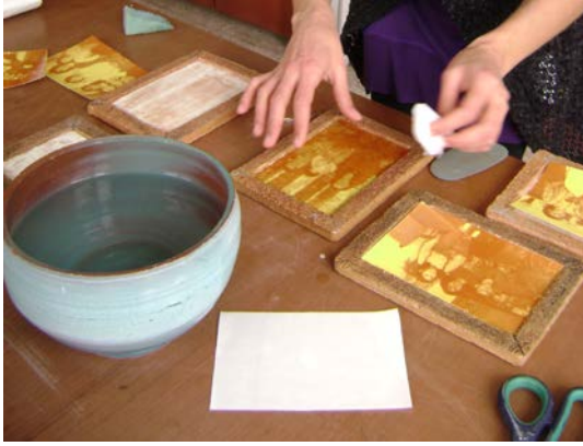
Resim 53. Sudan alınan laklı desenin seramik bünye üzerine yerleştirilmesi ve fil kulağı yardımıyla havasının alınması
