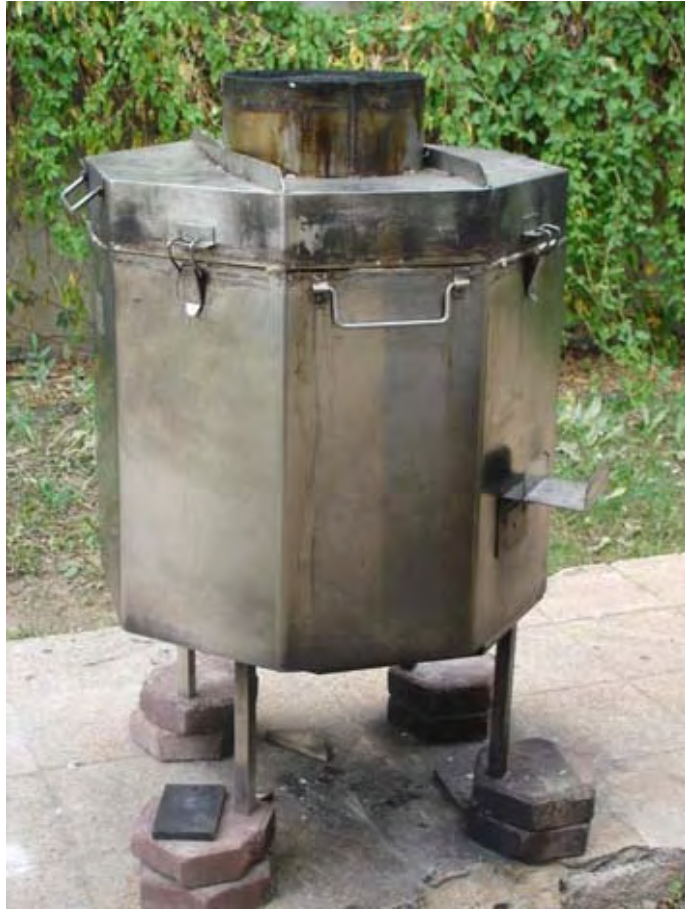
Resim 56. Bakır Kırmızısı Sırların Pişiriminde Kullanılmak Üzere Hazırlanan Gazlı Fırın
