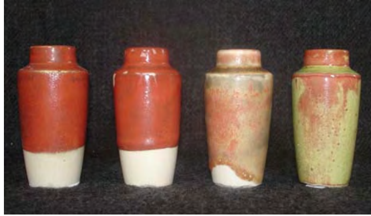
Resim 67. 1200°C Sıcaklıkta Gelişebilen Üç Boyutlu Bakır Kırmızısı Sır Araştırması Pişirim Sonuçları
