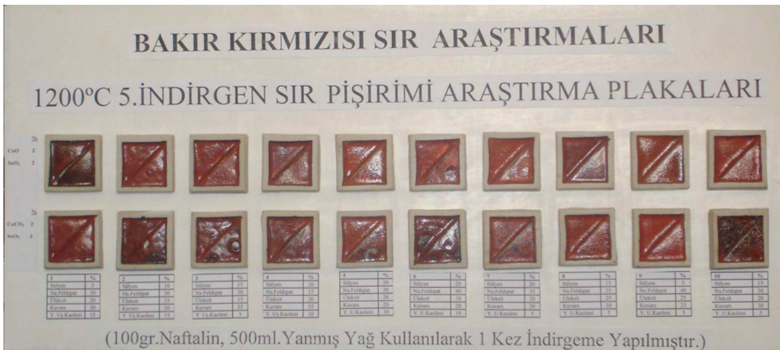
Resim 77. 1200°C Sıcaklıkta Gelişebilen Bakır Kırmızısı Beşinci İndirgen Sır Pişirimi Araştırma Plakaları
