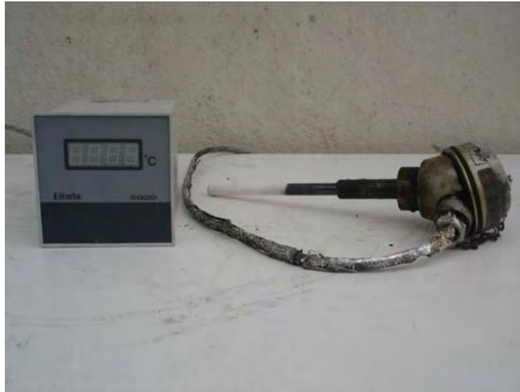
Resim 58. Gazlı Fırında Kullanılan Platin-Platin Rodyum Termokupl ve Gösterge Cihazı
