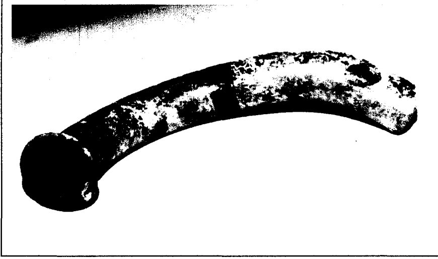
Şekil. 6.21. Emme manifoldu borusunda koruyucu primer boya tabakası eksikliğinden dolayı oluşmuş hasar
