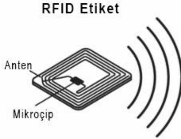
Şekil 2.6 RFID Etiketi teknik resmi ( http-1 )
