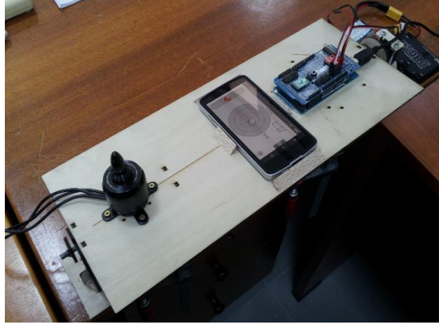
Şekil 6.4. Açı ölçüm testleri için imal edilen tek eksen test düzeneği
