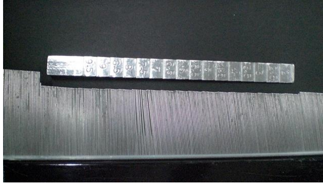
Şekil 2.8. Ürün yüzeyindeki deformasyonun belirlenmesinde kullanılan tasarım tarağı ve sentil çakısı
