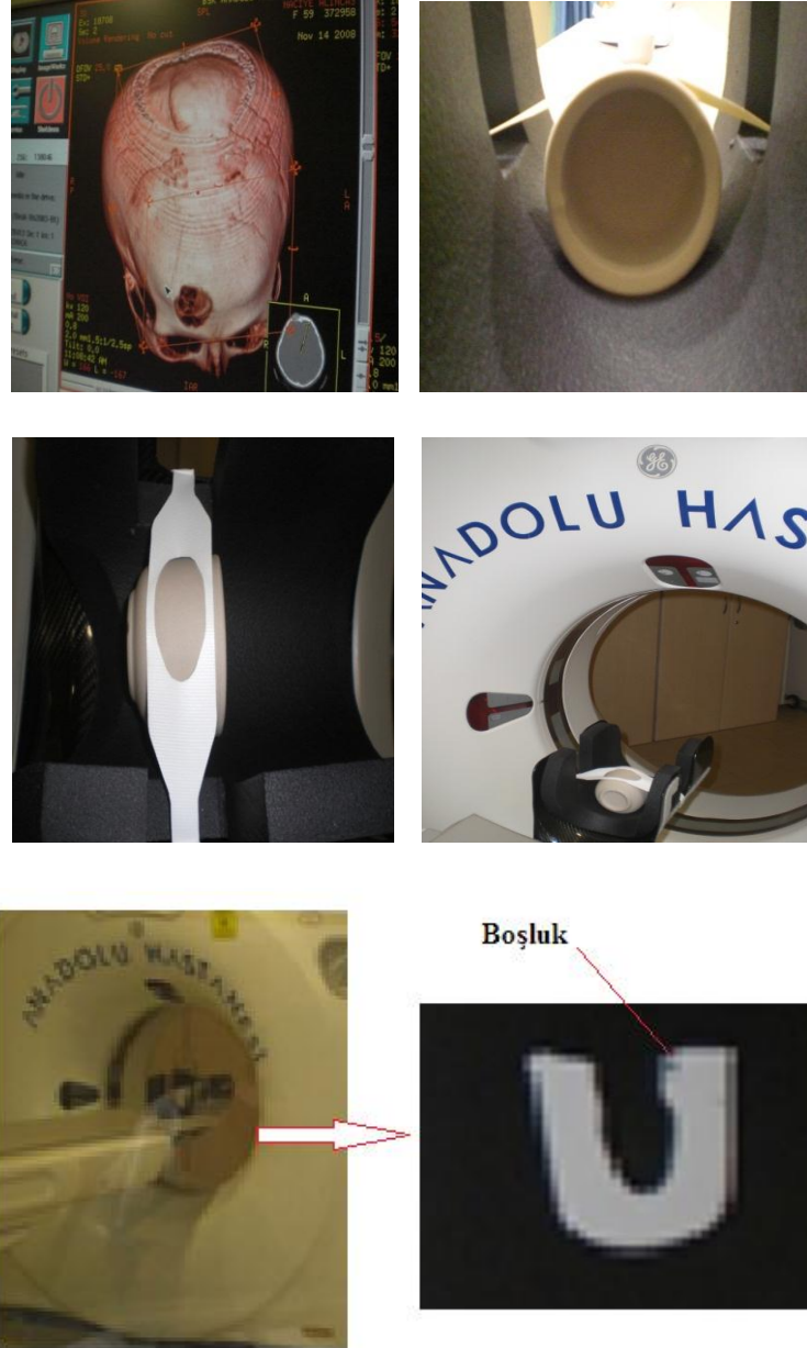
Şekil 4.20. Çamurdaki hataların tespitine yönelik yapılan tomografi çalışması
