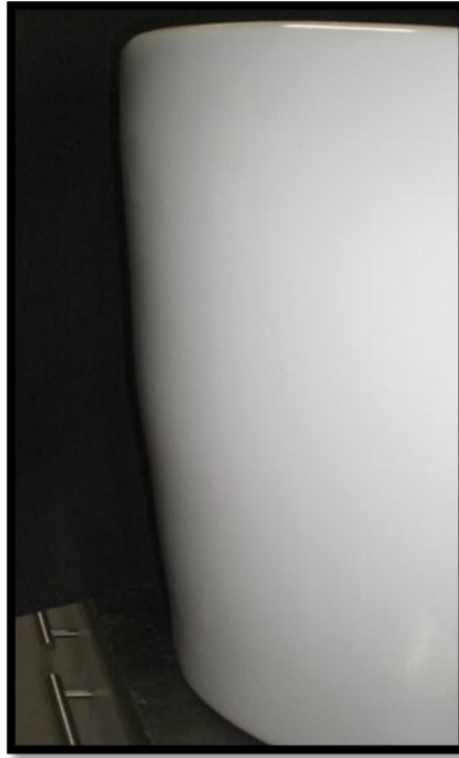
Şekil 6.11. Haznesi kesilerek pişirilen ürünün ön ortasında boğum izi ve deformasyonların görünüşü
