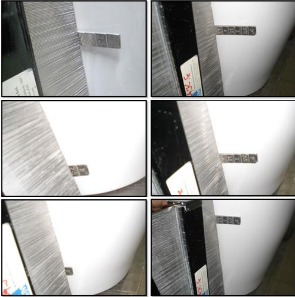
Şekil 6.5. Farklı tepe sıcaklıklarında pişirilmiş ürünlerin yüzeylerinde gözlemlenen en belirgin deformasyonların tasarım tarağı ve sentil çakısı ile ölçülmesi
