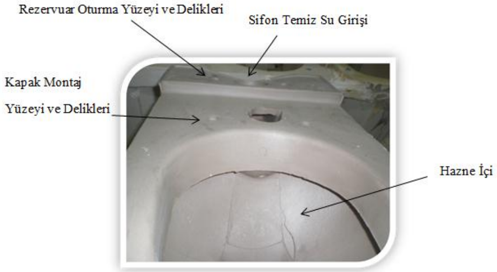
Şekil 2.4. Hazne içi, rezervuar oturma yüzeyi, temiz su girişi, kapak montaj yüzeyi ve delikleri
