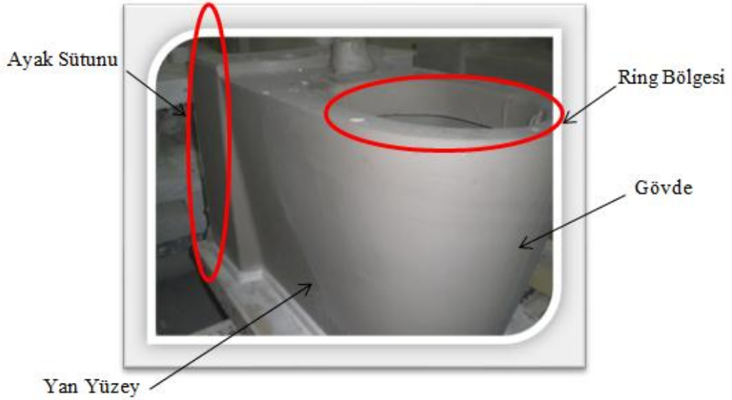
Şekil 2.3. Klozetin gövdesi, yan yüzeyi, ring bölgesi, ayak sütunu
