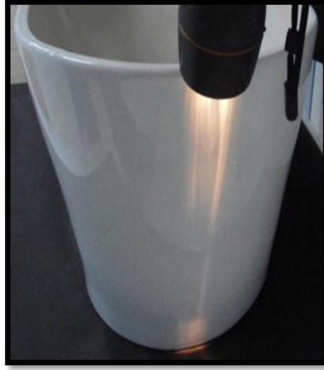
Şekil 6.9. Ringsiz pişirilen klozetin ön bölgesinde ışık taraması
