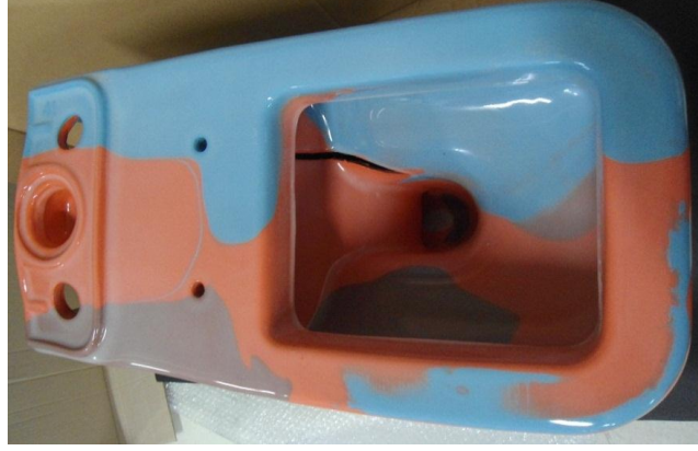
Şekil 4.25. Renkli döküm denemesinde çatlak görünümü
