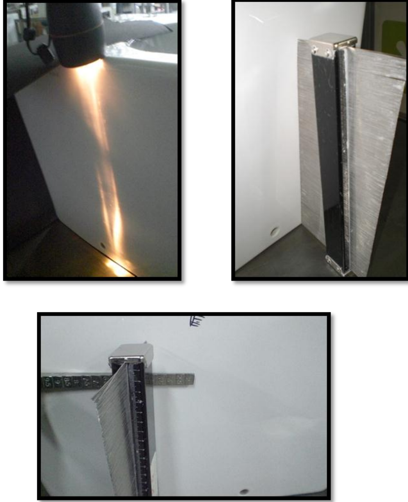
Şekil 6.2. Ürün üzerindeki deformasyonun ışık ile gözlemlenmesi ile tasarım tarağı ve sentil çakısı kullanılarak ölçülmesi
