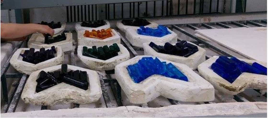
Görsel 154. Alçı kuvars kalıpların kalın cam çubuklarla doldurulması Fotoğraf: A. Manafidizaji
