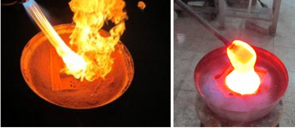
Görsel 127. Kalıbın karbonlanması ve sıcak cam dökümü aşaması Fotoğraflar: E. Küçükbiçmen
