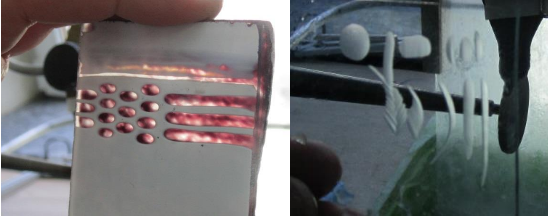
Görsel 98. Küçük boyutlu elmas diskleri ile elde edilebilen farklı yüzeysel izler Fotoğraflar: E. Küçükbiçmen
