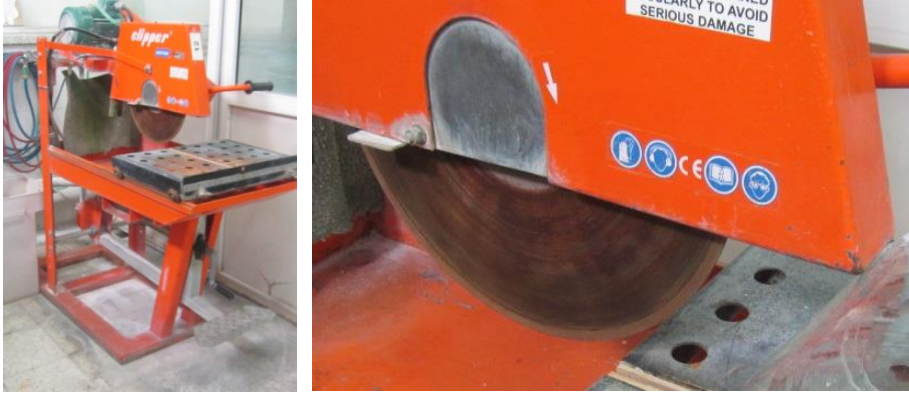
Görsel 110. Elmas disk ile cam kesimi yapılan makine
