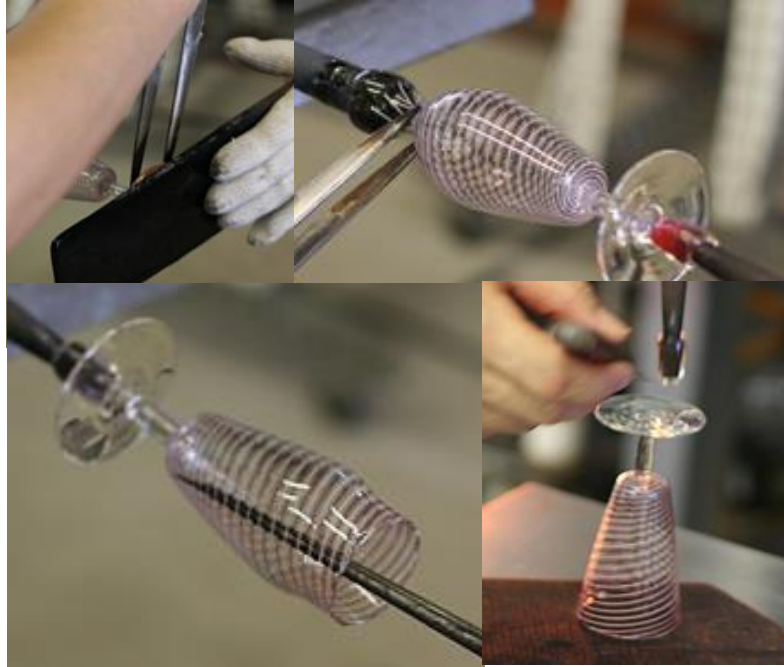
Görsel 26. Ayağın düzeltilip puntiyeye alınması, Ağızın açılması, kadehin puntiden ayrılması Fotoğraf: E. Küçükbiçmen, 2008
