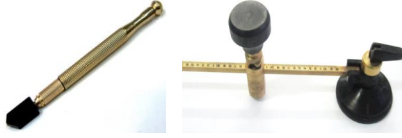
Görsel 117. Yağ hazneli ve yuvarlak kesim yapan elmas uçlu kesiciler Fotoğraflar: E. Küçükbiçmen
