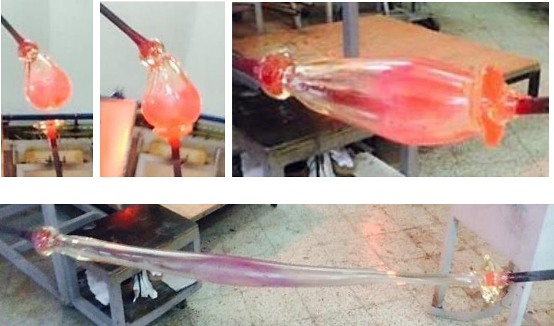
Görsel 55. Çekme ile cam boru şekillendirme aşamaları
