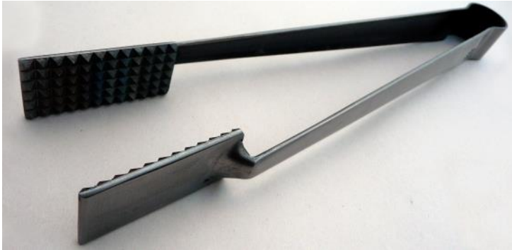
Görsele 50. Camda doku verilmek üzere kullanılan maşa
