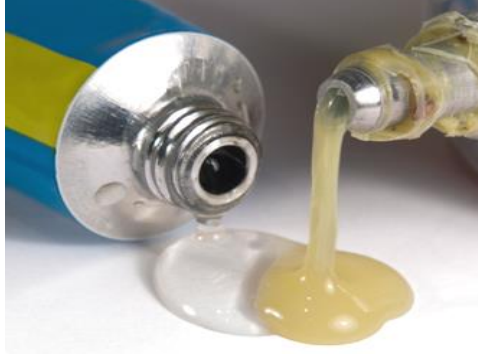
Görsel 122. Epoksi türü çift bileşenli yapıştırıcının karıştırılması
