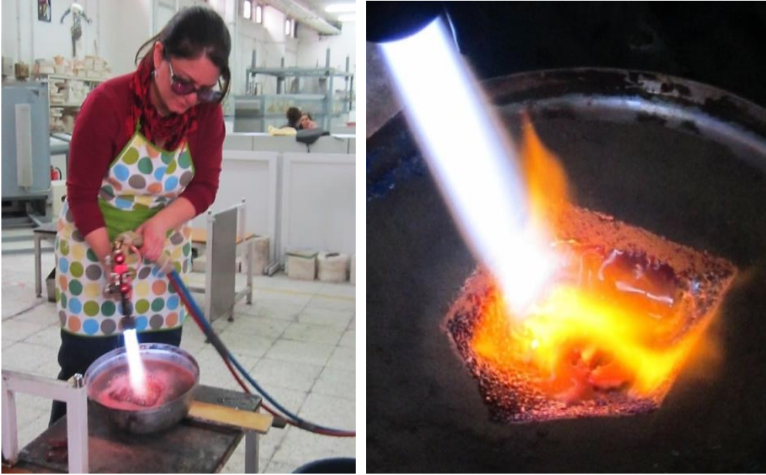
Görsel 158. Kum kalıp içindeki renkli cam granüllerin pürmüz ile kaynaştırılması Fotoğraflar: A. Tellez Leos
