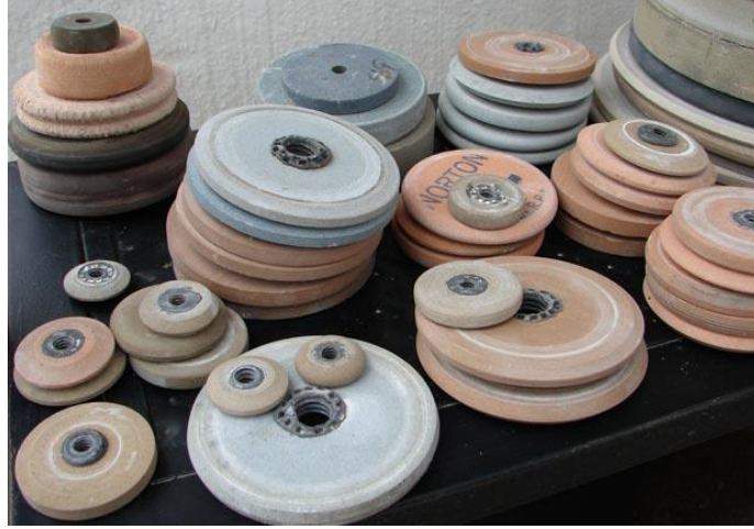
Görsel 102. Farklı boyut ve tane iriliğine 1,2 - 18cm arasında farklı çaplarda taş diskler Kaynak: http://jamesriser.com/StoneWheels/StoneWheelItems.html
