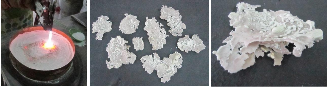
Görsel 146. Şeffaf ambalaj cam tozu ile yapılan çalışmadan elde edilen parçalı, katmanlı yapı
