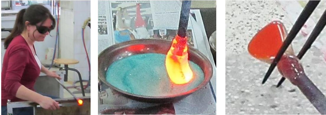
Görsel 133. Sıcak camın, metal çubuk ucunda renklendirilip şekillendirilmesi Fotoğraflar: F. Yılmaz
