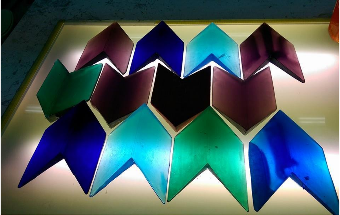
Görsel 155. Fırın içerisinde kalıpların şeklini almış, kalıptan çıkarılan cam formlar Fotoğraf: E. Küçükbiçmen
