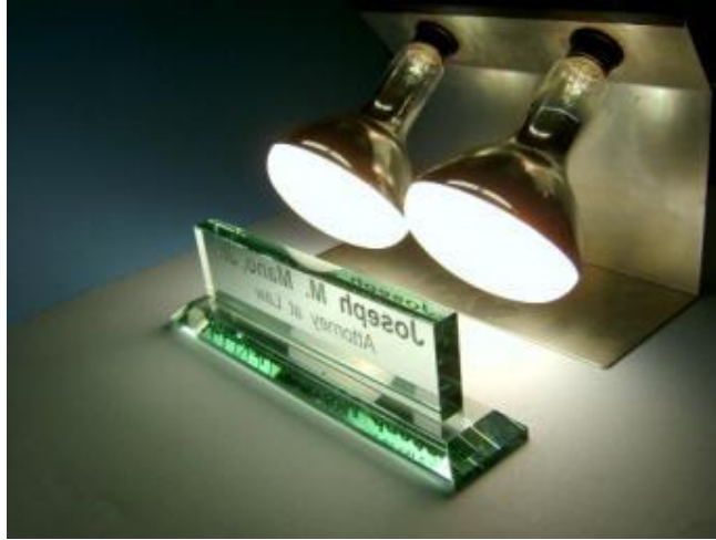
Görsel 124. Ultra Viyole Yapıştırıcı ile cam Yapıştırma aşaması
