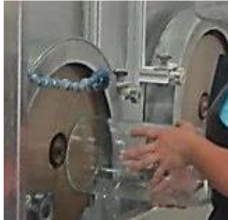
Görsel 91. Yatay elmas disk ile cam düzeltme aşaması Fotoğraf: B. Gamsız
