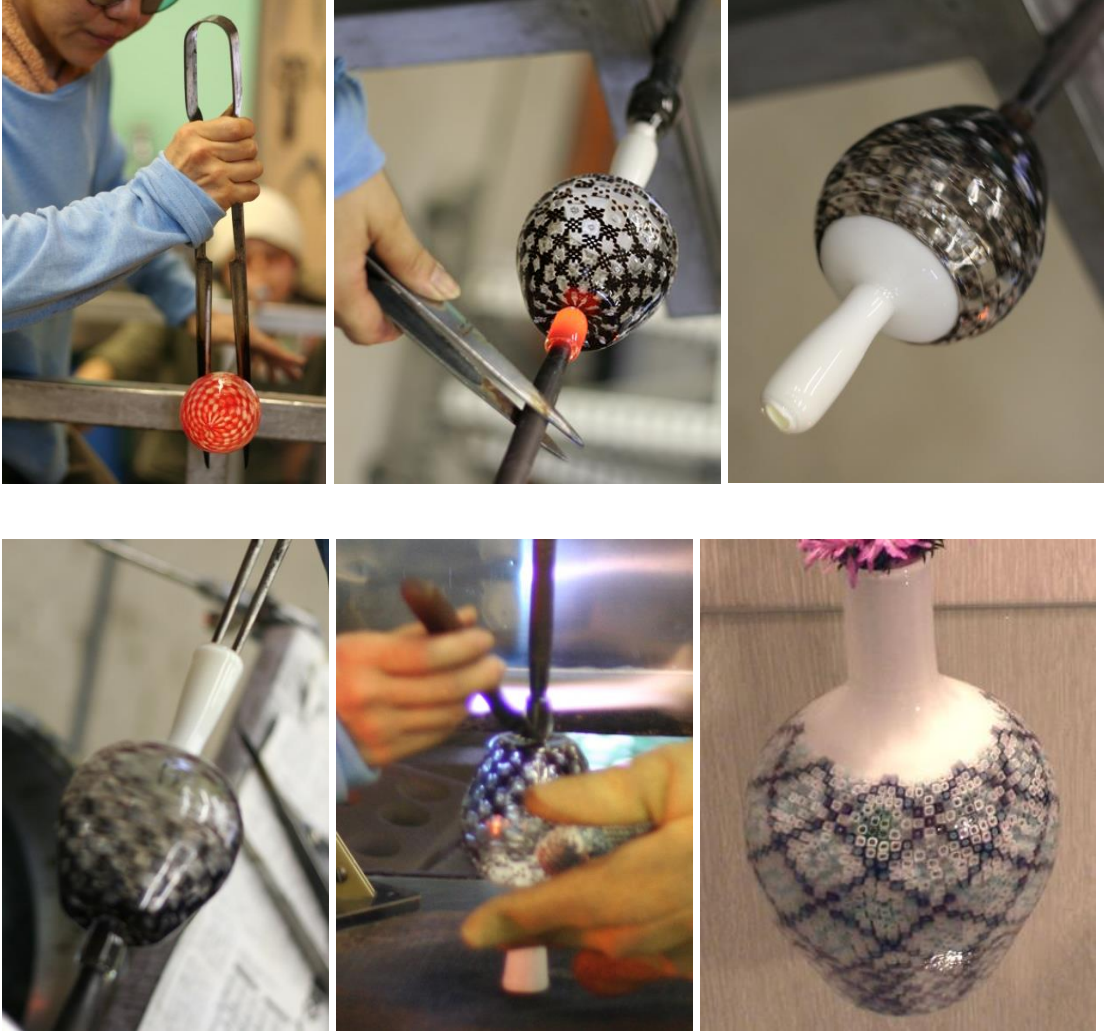
Görsel 43. Yuvarlama (roll-up) tekniğinde yapılan vazonun son aşamaları Fotoğraflar: E. Küçükbiçmen
