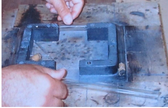
Görsel 75. Kalıp ile üfleme, Yaman Cam Atölyesi, Ankara, 2004
