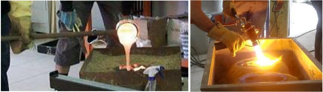
Görsel 19. Kuma döküm ile şekillendirme; Marmara Üniv. GSF, 2011 Fotoğraf: E. Küçükbiçmen
