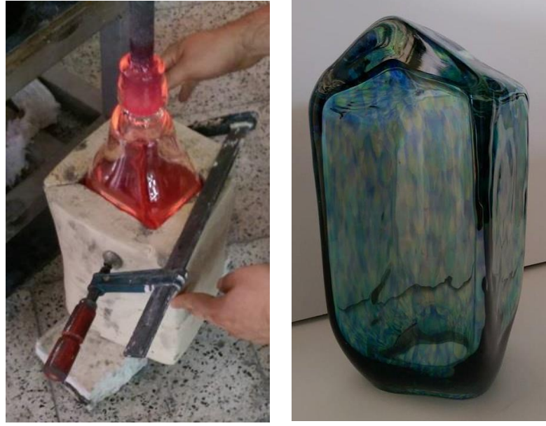
Görsel 157. Kalıp içine sıcak cam üfleminin aşamaları ve soğutulmuş parça Fotoğraflar: E. Küçükbiçmen
