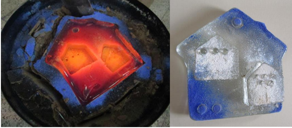
Görsel 128. Kum kalıbı içinde soğumaya başlayan ve soğumuş cam çalışması Fotoğraflar: E. Küçükbiçmen
