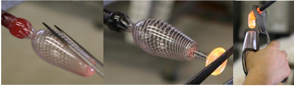
Görsel 25. Haznenin şekillendirilmesi Gövde ve ayak kısımlarının eklenmesi Fotoğraf: E. Küçükbiçmen, 2008
