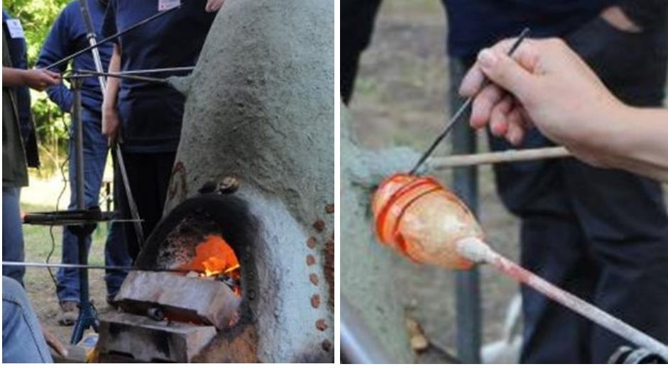
Görsel 86. İç kalıp üzerine sıcak cam sarma örneği. Uygulama: E. Küçükbiçmen 2010 Fotoğraf: K. Kerstna
