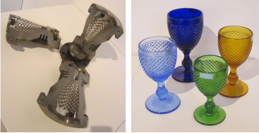
Görsel 46. Ayaklı cam kadehlerin yapımında kullanılan çok parçalı çelik kalıp ve ürünler, Cam Müzesi, Porto Fotoğraflar: E. Küçükbiçmen, 2013
