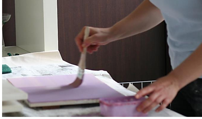
Görsel 58. Üzerinde cam füzyonu yapılacak fırın rafına fırça ile ayırıcı sürülmesi Fotoğraf: F. Enami
