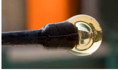
Görsel 23. İlk üfleme ile oluşan hava kabarcığı Kaynak: http://entertainment.howstuffworks.com/arts/artwork/glassblowing2.htm
