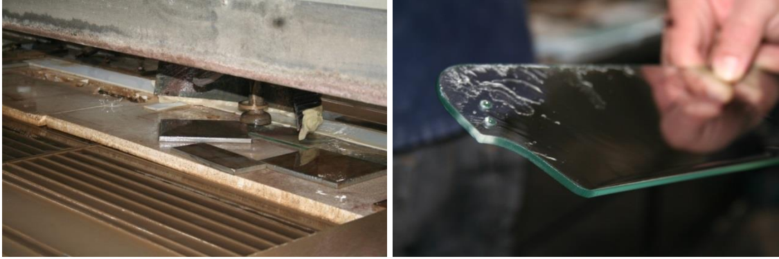
Görsel 115. Su jeti ile kesim aşamasından görüntü (Hatipoğlu Cam Fab., Eskişehir) Fotoğraflar: E. Küçükbiçmen
