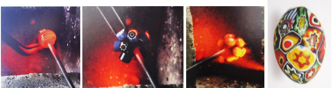
Görsel 82. Ekleme ile şekillendirme örneği millefiori boncuk yapımı aşamaları Kaynak: Moretti, 2009: 47
