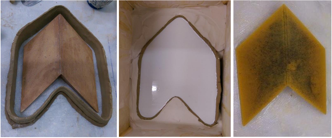
Görsel 153. Alçı çekirdek, üzerinden alınan silikon kalıp ve elde edilen balmumu form Fotoğraflar: E. Küçükbiçmen
