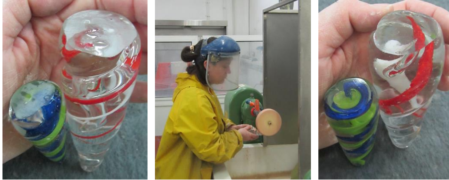
Görsel 105. Camların keçe diskte pomza tozu ve ardından seryum oksitle parlatılması Fotoğraflar: E. Küçükbiçmen, K. Atalay, E. Küçükbiçmen
