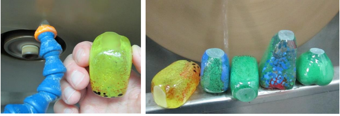
Görsel 134. Cam formların dikey rodaj makinalarında düzeltilip, çapaklarının alınması Fotoğraflar: E. Küçükbiçmen
