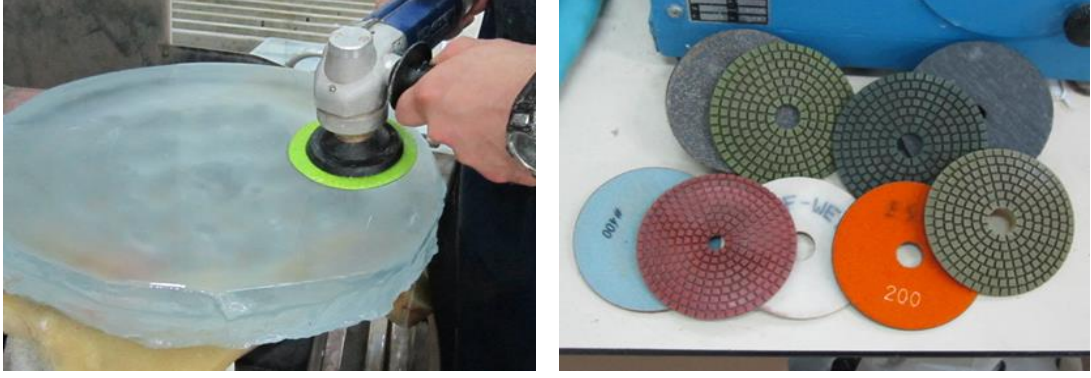
Görsel 104. Zımparalama ve makine başlık kısmına takılır zımpara ve parlatma uçları Fotoğraflar: E. Küçükbiçmen
