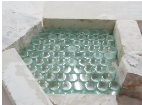
Görsel 141. Fırın board yüzeyinin düzeltilmesi ve füzyon için dizilmiş parçacıklar
