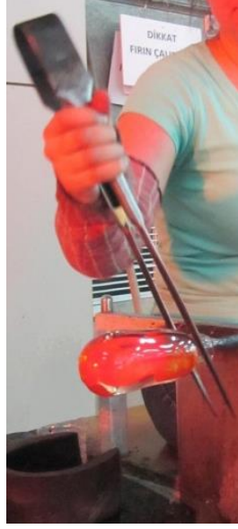
Görsel 139. Cam kütleli ‘boğma’ aşaması ve tamamlanmış bir parça Fotoğraflar: F.Yılmaz, E. Küçükbiçmen
