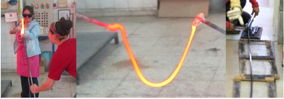
Görsel 54. Sıcak camın iki cam şekillendirme çubuğu ucunda çekilerek çubuk haline getirilmesi ve istiflenmesi
