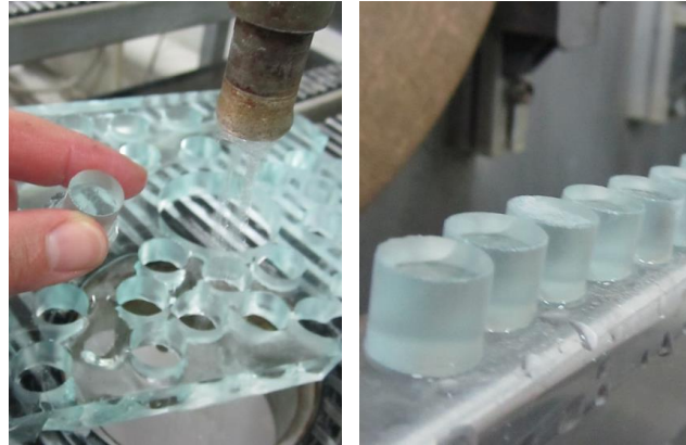
Görsel 114. Elmas cam delme makinasında şekillendirilmiş cam parçacıkları
