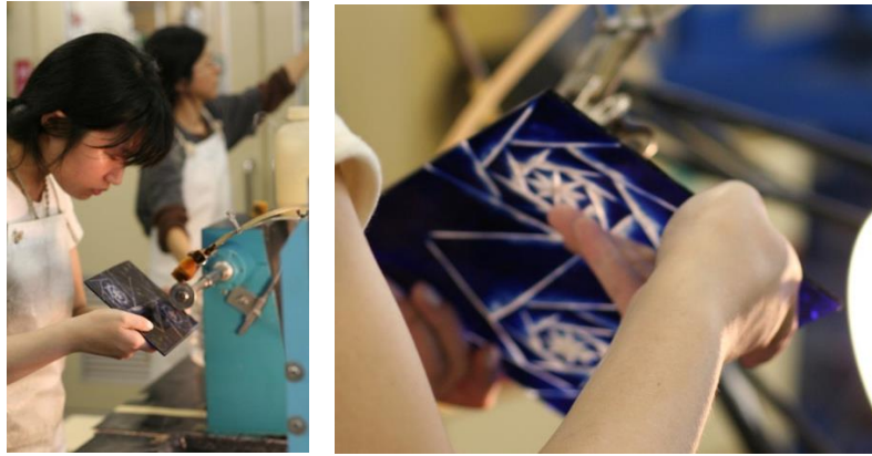
Görsel 95. Elmas disk kullanılarak cam yüzeyinin şekillendirilmesi Fotoğraf: E. Küçükbiçmen
