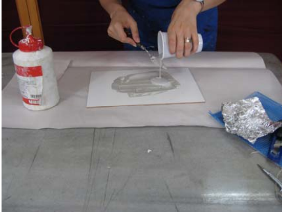
Resim 27 Çimento ve Tutkal Karışımının MDF Üzerine Yayılması
