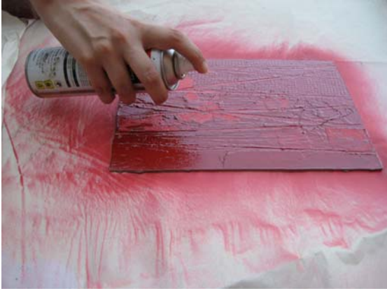
Resim 35 Kurumuş Kalıbın Üzerine Oto Boyası Püskürtülmesi
