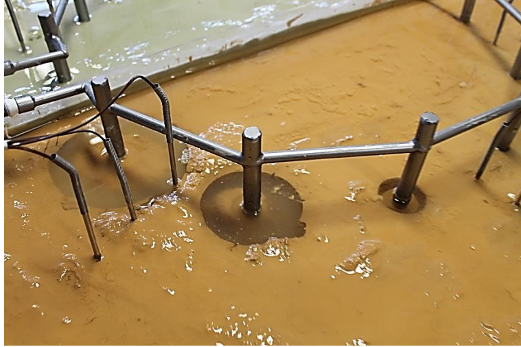
Görsel E2.8. Sıvı Azot Dolaşımı ile YZD; Sırasıyla Donma Öncesi, Donma Sonu ve Çözülme Sonu – Küçük Boy Paslanmaz Çelik Boru – CL Tipi Numune
