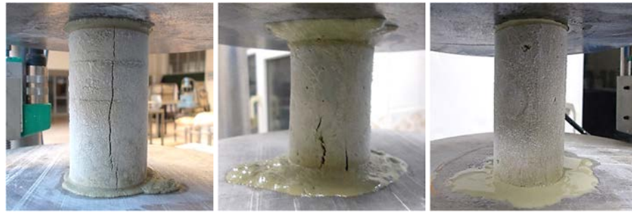
Görsel 6.2. Su Muhtevası Değişimine Bağlı Göçme Modları; a. -20 °C, CL, b. -200 °C, CL, c. -20 °C, ML, d. -200 °C, ML, e. -20 °C, SP ve f. -200 °C, SP (Her Değişken Kendi İçerisinde Sırasıyla -%10, Optimum ve +%10 Su Muhtevası Değerlerini İçermektedir)
