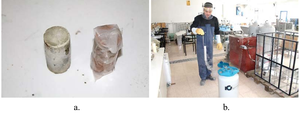
Görsel 5.3. a. Kanisterli Sıvı Azot Tankında Bekletilmek Üzere Hazırlanan Numuneler ve b. Numunelerin Yerleştirilmesi
