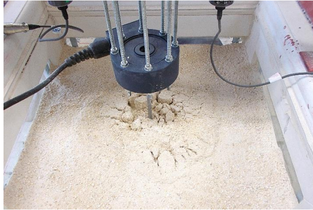
Görsel E9.3. Sıkı Kuru Kumda 15 cm Çap İçin Sırasıyla 0.5, 1.0, 1.5 ve 2.0 Ankraj Derinliği / Ankraj Çapı Oranlarında Yüzeyledeki Göçme Durumları
