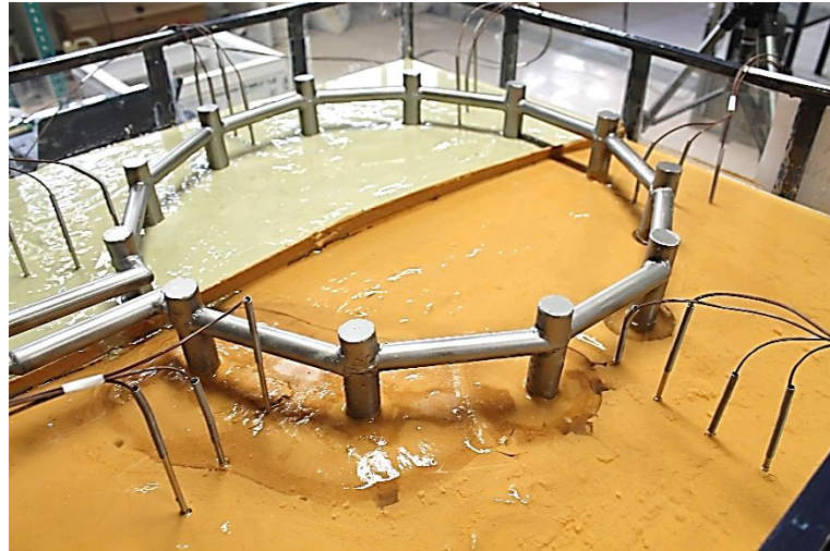
Görsel E2.6. Sıvı Azot Dolaşımı ile YZD; Sırasıyla Donma Öncesi, Donma Sonu ve Çözülme Sonu – Orta Boy Paslanmaz Çelik Boru – CL Tipi Numune
