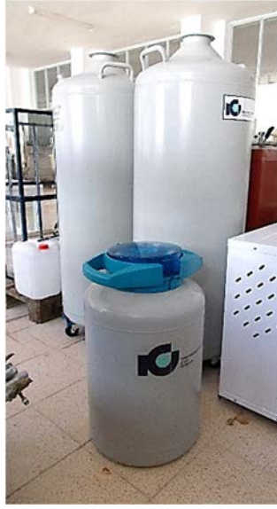
Görsel 4.5. Sıvı Azot İçin Alınan Saklama, Taşıma ve Kanister Sistemli Tanklar
