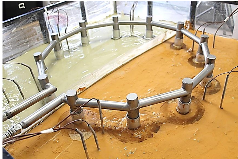
Görsel E4.6. Sıvı Azot Dolaşımı ile YZD; Sırasıyla Donma Öncesi, Donma Sonu ve Çözülme Sonu – Orta Boy Alüminyum Boru – CL Tipi Numune
