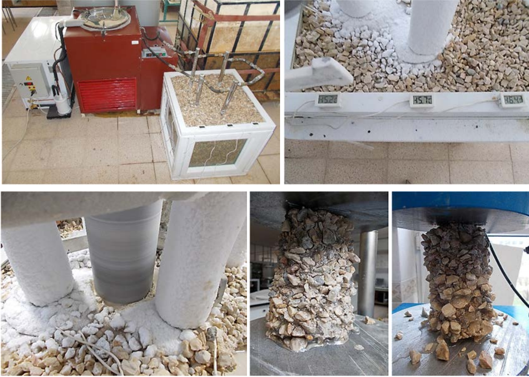
Görsel 6.13. Donma Sonrası Karot Alma İşlemi ve Serbest Basınç Deneyi
