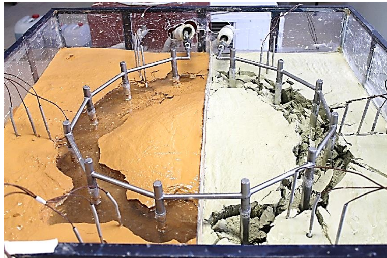
Görsel E4.3. Antifriz Dolaşımı ile YZD; Sırasıyla Donma Öncesi, Donma Sonu ve Çözülme Sonu – Küçük Boy Alüminyum Boru
