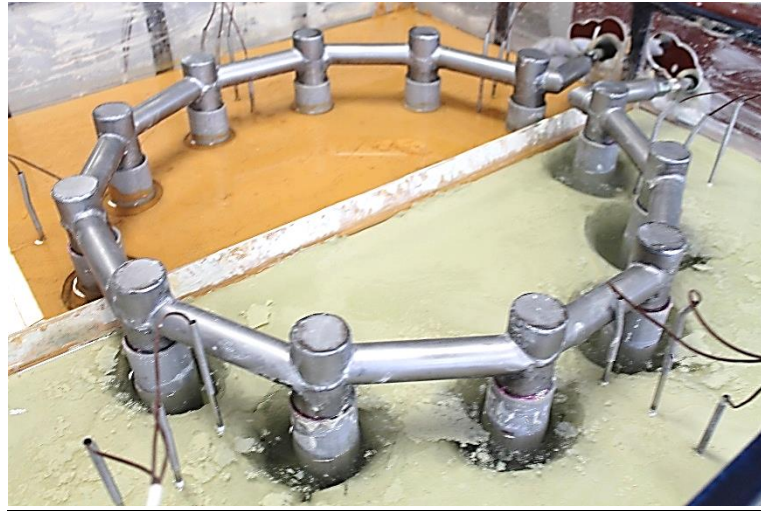
Görsel E6.5. Sıvı Azot Dolaşımı ile YZD; Sırasıyla Donma Öncesi, Donma Sonu ve Çözülme Sonu – Büyük Boy HDPE Boru – ML Tipi Numune
