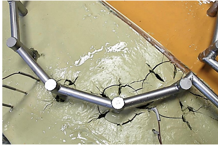
Görsel E2.7. Sıvı Azot Dolaşımı ile YZD; Sırasıyla Donma Öncesi, Donma Sonu ve Çözülme Sonu – Orta Boy Paslanmaz Çelik Boru – ML Tipi Numune
