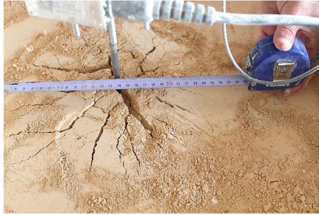
Görsel E10.5. Kuru Kilde 20 cm Çap İçin Sırasıyla 0.5, 1.0, 1.5 ve 2.0 Ankraj Derinliği / Ankraj Çapı Oranlarında Yüzeyledeki Göçme Durumları
