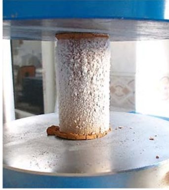
Görsel 5.5. Eksenel Basınç Deneyi Sonrası Numunelerde Meydana Gelen Kırılma Biçimleri, a. Azot Tankında Bekletilen -%10 Su Muhtevsındaki ML Numunesi, b. Azot Tankında Bekletilen Optimum Su Muhtevsındaki CL Numunesi ve c. CDF Cihazında Bekletilen -%10 Su Muhtevsındaki CL Numunesi
