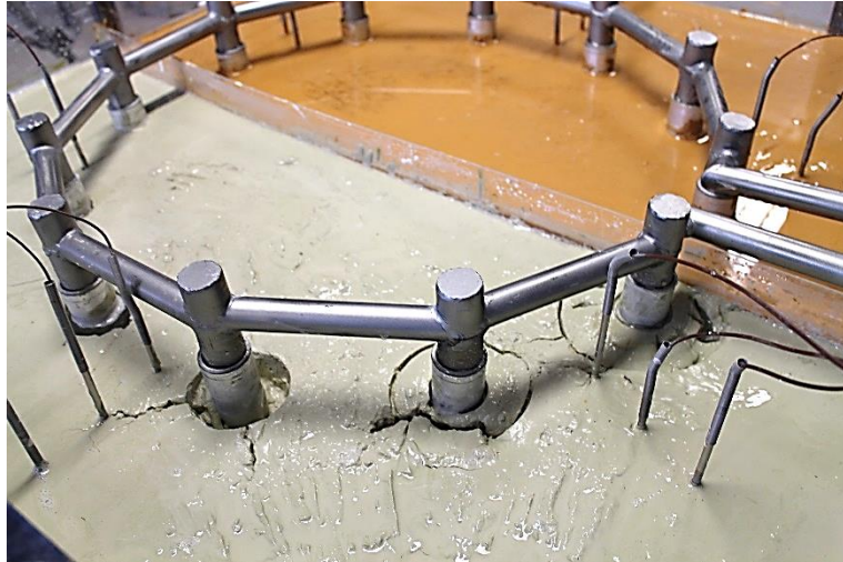
Görsel E4.7. Sıvı Azot Dolaşımı ile YZD; Sırasıyla Donma Öncesi, Donma Sonu ve Çözülme Sonu – Orta Boy Alüminyum Boru – ML Tipi Numune
