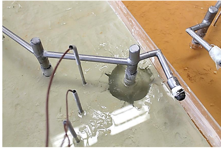
Görsel E4.9. Sıvı Azot Dolaşımı ile YZD; Sırasıyla Donma Öncesi, Donma Sonu ve Çözülme Sonu – Küçük Boy Alüminyum Boru – ML Tipi Numune
