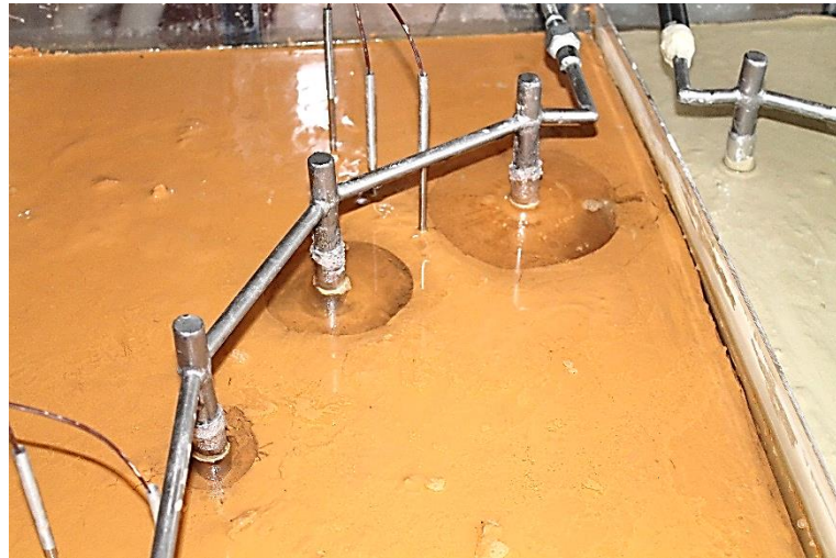
Görsel E4.8. Sıvı Azot Dolaşımı ile YZD; Sırasıyla Donma Öncesi, Donma Sonu ve Çözülme Sonu – Küçük Boy Alüminyum Boru – CL Tipi Numune
