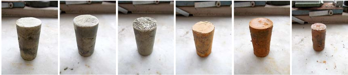
Görsel 5.1. a. Farklı Su İçeriğindeki Deneme Numuneleri ve b. Ön Dondurma İşlemi
