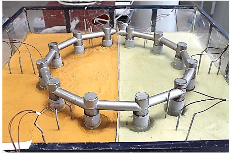
Görsel E6.4. Sıvı Azot Dolaşımı ile YZD; Sırasıyla Donma Öncesi, Donma Sonu ve Çözülme Sonu – Büyük Boy HDPE Boru – CL Tipi Numune
