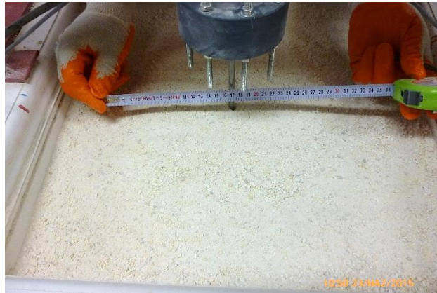
Görsel E8.4. Gevşek Kuru Kumda 20 cm Çap İçin Sırasıyla 0.5, 1.0, 1.5 ve 2.0 Ankraj Derinliği / Ankraj Çapı Oranlarında Yüzeyledeki Göçme Durumları
