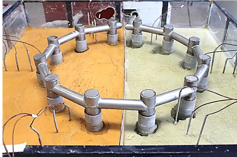
Görsel E6.1. Antifriz Dolaşımı ile YZD; Sırasıyla Donma Öncesi, Donma Sonu ve Çözülme Sonu – Büyük Boy HDPE Boru
