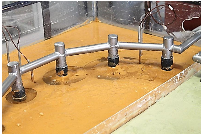
Görsel E6.6. Sıvı Azot Dolaşımı ile YZD; Sırasıyla Donma Öncesi, Donma Sonu ve Çözülme Sonu – Orta Boy HDPE Boru – CL Tipi Numune
