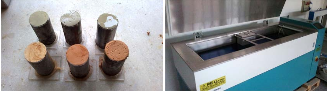
Görsel 5.1. a. Farklı Su İçeriğindeki Deneme Numuneleri ve b. Ön Dondurma İşlemi
