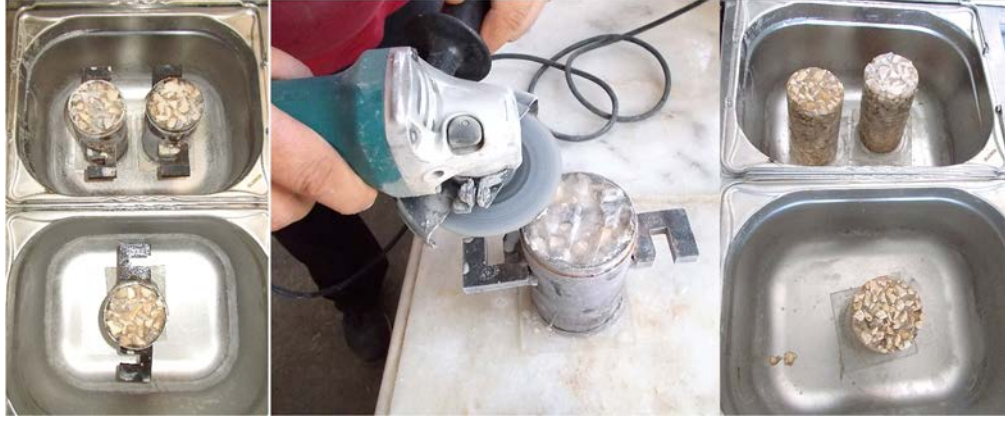
Görsel 6.11. Doğal Koşullarda Numune Hazırlama İşlemi
