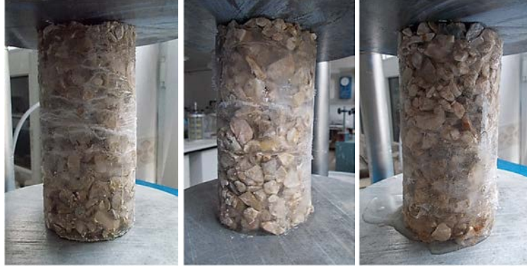
Görsel 6.12. Donmuş Numunelerin Göçme Sonrası Durumları
