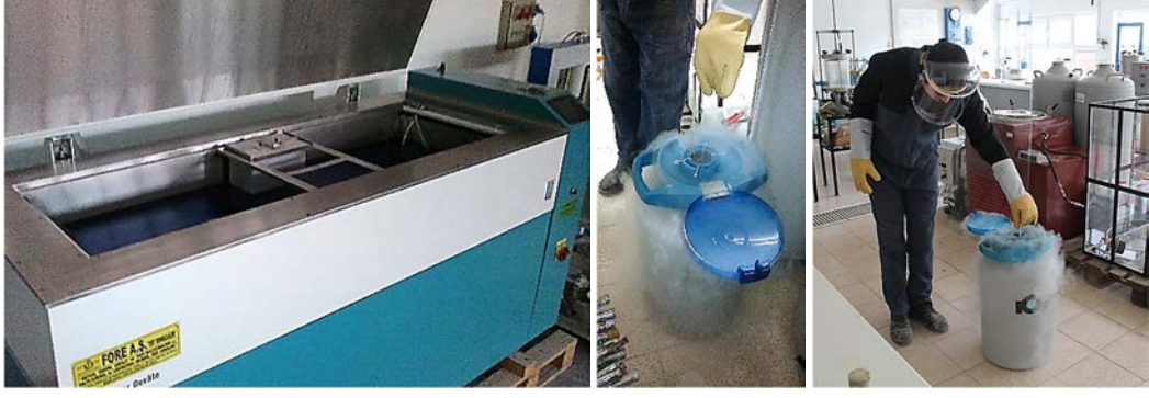
Görsel 6.3. Donma İşleminin Uygulanması, a. CDF/CIF Cihazı ve b-c. Kanisterli Sıvı Azot Tankı
