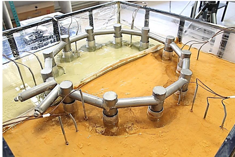
Görsel E4.4. Sıvı Azot Dolaşımı ile YZD; Sırasıyla Donma Öncesi, Donma Sonu ve Çözülme Sonu – Büyük Boy Alüminyum Boru – CL Tipi Numune
