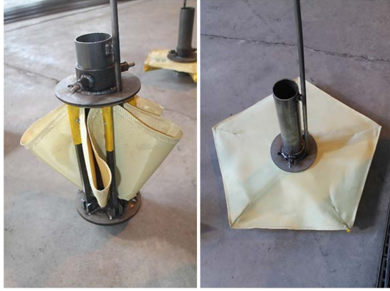
Görsel 13.9. Düz Şemsiye Ankraj; a. Kapalı Konum ve b. Açık Konum
