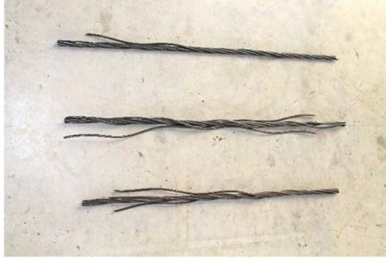
Görsel 15.4. Ankraj Halatının Kopması Durumu
