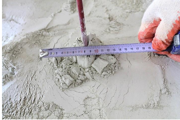
Görsel E10.1. Kuru Siltte 5 cm Çap İçin Sırasıyla 1.0, 1.5 ve 2.0 Ankraj Derinliği / Ankraj Çapı Oranlarında Yüzeydeki Göçme Durumları
