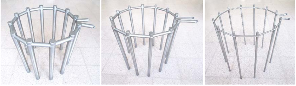
Görsel 6.16. Sabit Paslanmaz Çelik Dolaşım Boruları
