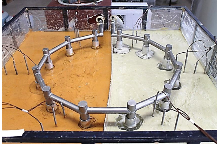
Görsel E4.2. Antifriz Dolaşımı ile YZD; Sırasıyla Donma Öncesi, Donma Sonu ve Çözülme Sonu – Orta Boy Alüminyum Boru
