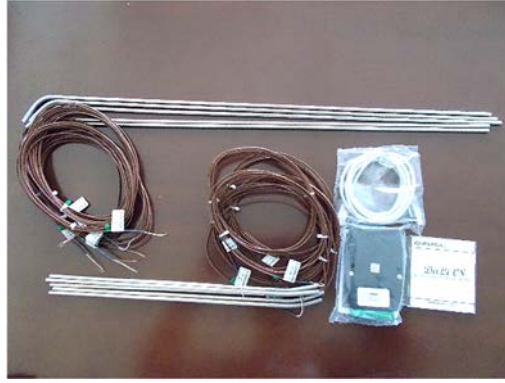
Görsel 4.6. T Tipi Isiölçerler ve Veri Toplama Cihazı
