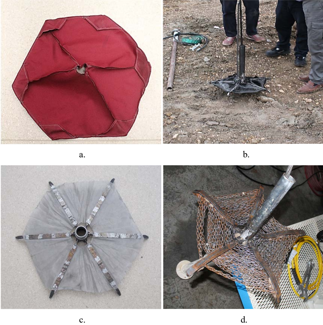
Görsel 13.14. Deneme Uygulamalarında Kullanılan Gerji Elemanları; a. Branda, b. Karbon Lifli Polimer (CFRP), c. Metal Elek, d. Zincir, e. Aramid Kumaş ve f. Aramid Kumaşın Perçin ile Sabitlenmesi,
