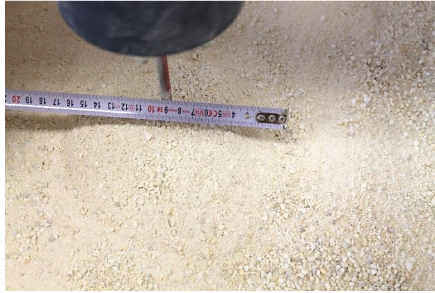
Görsel E9.2. Sıkı Kuru Kumda 10 cm Çap İçin Sırasıyla 0.5, 1.0, 1.5 ve 2.0 Ankraj Derinliği / Ankraj Çapı Oranlarında Yüzeyledeki Göçme Durumları
