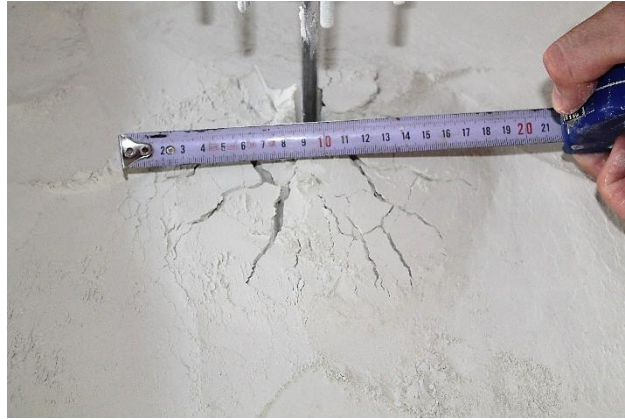
Görsel E10.3. Kuru Siltte 15 cm Çap İçin Sırasıyla 0.5, 1.0, 1.5 ve 2.0 Ankraj Derinliği / Ankraj Çapı Oranlarında Yüzeyledeki Göçme Durumları
