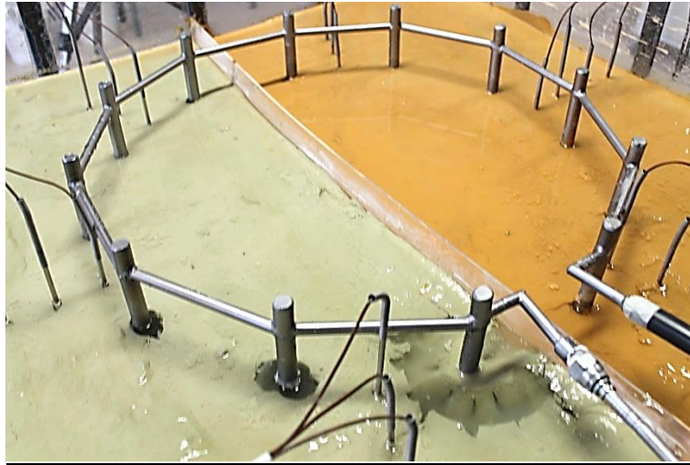
Görsel E2.9. Sıvı Azot Dolaşımı ile YZD; Sırasıyla Donma Öncesi, Donma Sonu ve Çözülme Sonu – Küçük Boy Paslanmaz Çelik Boru – ML Tipi Numune
