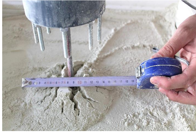
Görsel E10.2. Kuru Silte 10 cm Çap İçin Sırasıyla 0.5, 1.0, 1.5 ve 2.0 Ankraj Derinliği / Ankraj Çapı Oranlarında Yüzeyledeki Göçme Durumları
