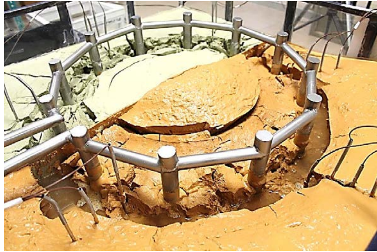
Görsel E2.2. Antifriz Dolaşımı ile YZD; Sırasıyla Donma Öncesi, Donma Sonu ve Çözülme Sonu – Orta Boy Paslanmaz Çelik Boru
