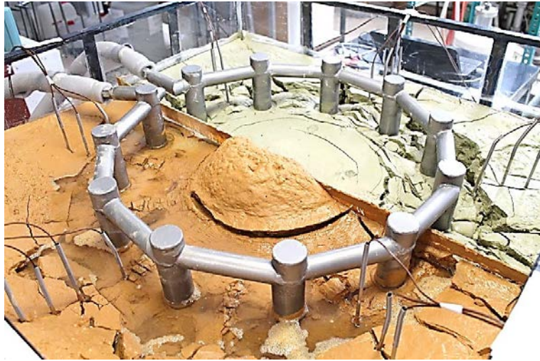
Görsel E2.1. Antifriz Dolaşımı ile YZD; Sırasıyla Donma Öncesi, Donma Sonu ve Çözülme Sonu – Büyük Boy Paslanmaz Çelik Boru
