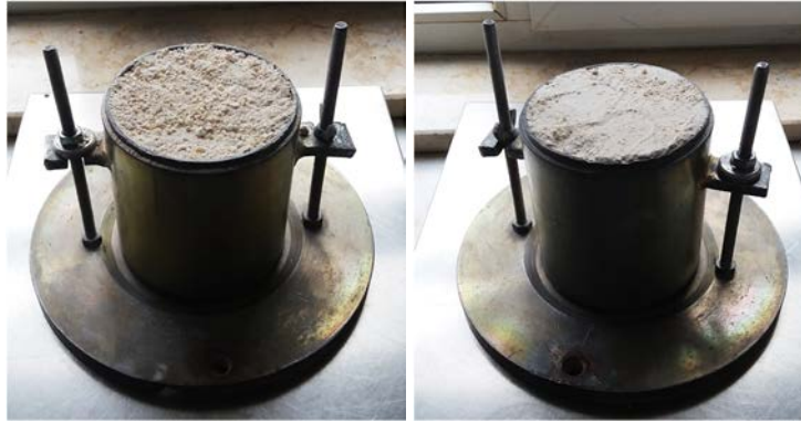
Görsel 12.3. Boşluk Oranı Hesabında Kullanılan Kalıp ve Numuneler; a. Gevşek Kum ve b. Sıkı Kum
