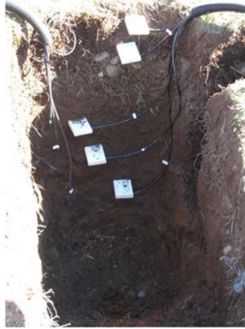
Görsel 2.4. P100 Tipi Sıcaklıkölçerlerin Yerleşimi Kaynak: Wu vd., 2011, s. 107
