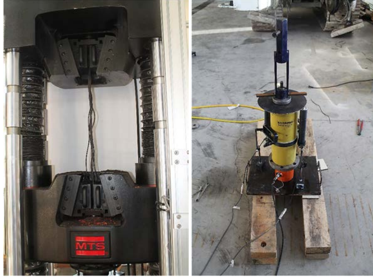
Görsel 14.2. Halat Çekme Deneyleri; a. MTS ve b. Harici Düzenek
