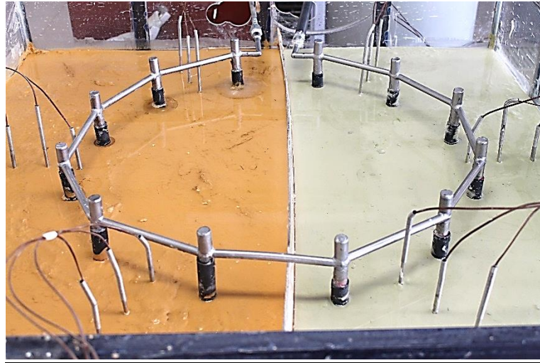
Görsel E6.8. Sıvı Azot Dolaşımı ile YZD; Sırasıyla Donma Öncesi, Donma Sonu ve Çözülme Sonu – Küçük Boy HDPE Boru – CL Tipi Numune
