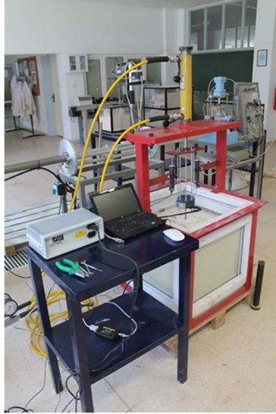
Görsel 12.5. Laboratuvarda Ankraj Çekme Sistemi
