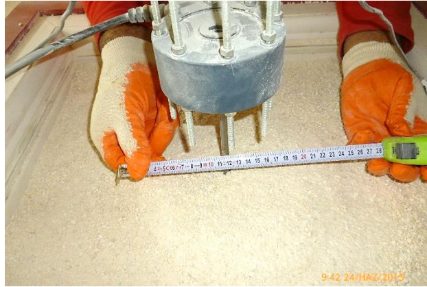
Görsel E8.3. Gevşek Kuru Kumda 15 cm Çap İçin Sırasıyla 0.5, 1.0, 1.5 ve 2.0 Ankraj Derinliği / Ankraj Çapı Oranlarında Yüzeyledeki Göçme Durumları
