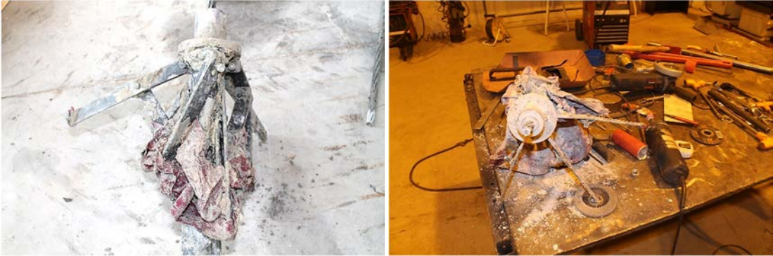
Görsel 15.1. Kanatların Burkulması ve Gergi Elemanın Yırtılması Durumu
