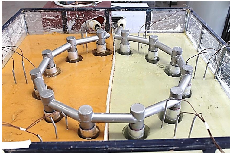
Görsel E4.1. Antifriz Dolaşımı ile YZD; Sırasıyla Donma Öncesi, Donma Sonu ve Çözülme Sonu – Büyük Boy Alüminyum Boru
