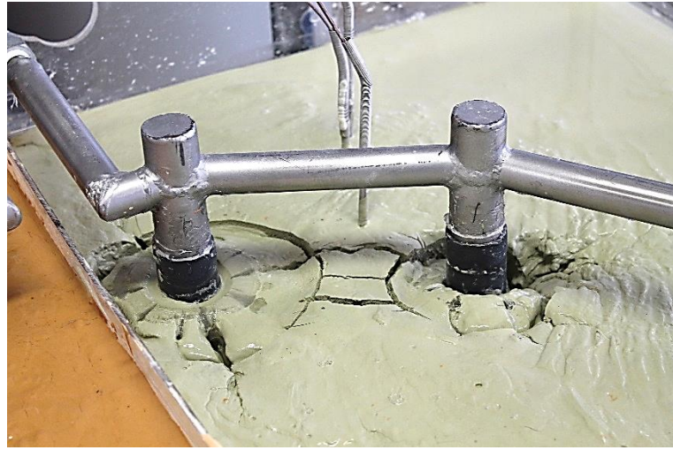
Görsel E6.7. Sıvı Azot Dolaşımı ile YZD; Sırasıyla Donma Öncesi, Donma Sonu ve Çözülme Sonu – Orta Boy HDPE Boru – ML Tipi Numune
