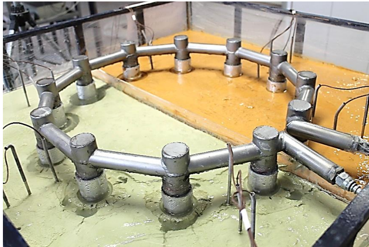
Görsel E4.5. Sıvı Azot Dolaşımı ile YZD; Sırasıyla Donma Öncesi, Donma Sonu ve Çözülme Sonu – Büyük Boy Alüminyum Boru – ML Tipi Numune
