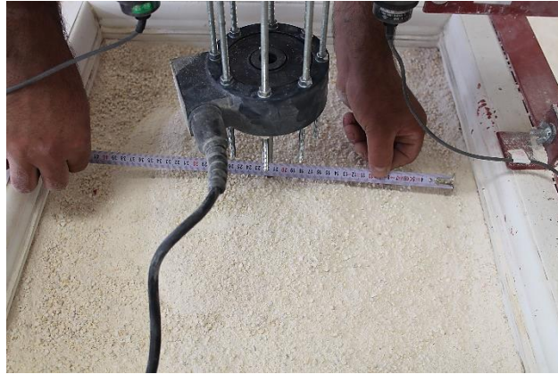
Görsel E9.4. Sıkı Kuru Kumda 20 cm Çap İçin Sırasıyla 0.5, 1.0, 1.5 ve 2.0 Ankraj Derinliği / Ankraj Çapı Oranlarında Yüzeyledeki Göçme Durumları
