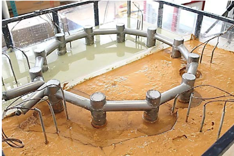
Görsel E2.4. Sıvı Azot Dolaşımı ile YZD; Sırasıyla Donma Öncesi, Donma Sonu ve Çözülme Sonu – Büyük Boy Paslanmaz Çelik Boru – CL Tipi Numune
