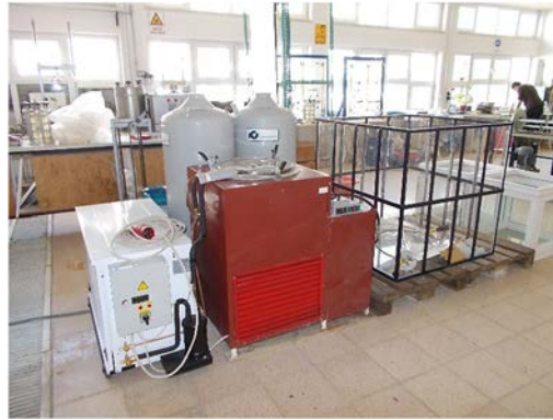
Görsel 4.4. Tez Kapsamında Üretilen Yapay Zemin Dondurma Cihazı
