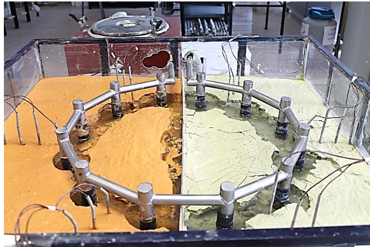
Görsel E6.2. Antifriz Dolaşımı ile YZD; Sırasıyla Donma Öncesi, Donma Sonu ve Çözülme Sonu – Orta Boy HDPE Boru
