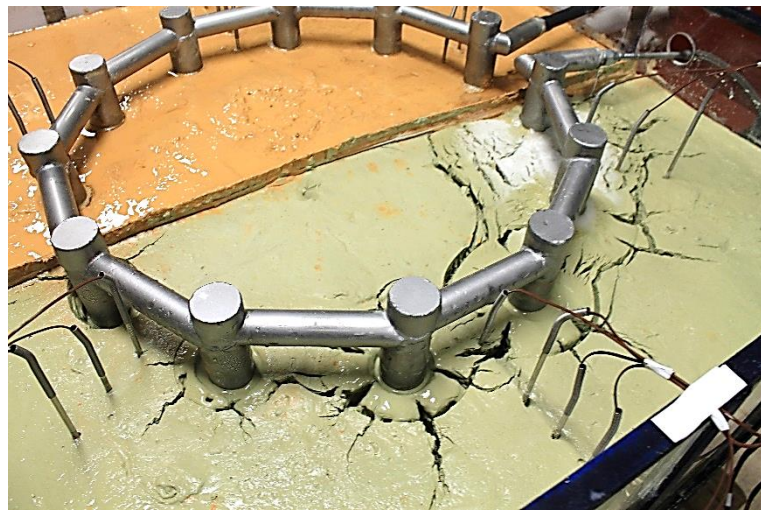
Görsel E2.5. Sıvı Azot Dolaşımı ile YZD; Sırasıyla Donma Öncesi, Donma Sonu ve Çözülme Sonu – Büyük Boy Paslanmaz Çelik Boru – ML Tipi Numune
