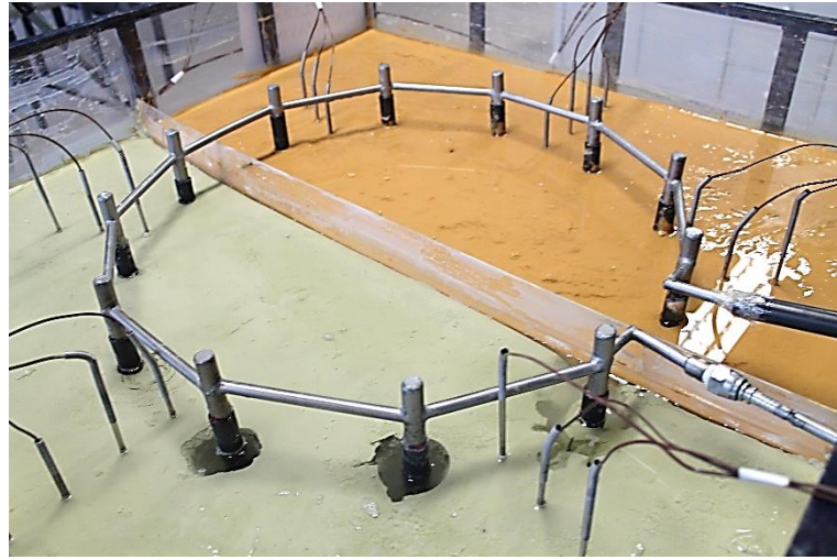
Görsel E6.9. Sıvı Azot Dolaşımı ile YZD; Sırasıyla Donma Öncesi, Donma Sonu ve Çözülme Sonu – Küçük Boy HDPE Boru – ML Tipi Numune
