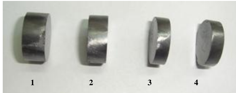
Şekil 3.8. \alpha -Si 3 N 4 tozuyla 22 MPa (1 ve 2) ve 220 MPa'da (3 ve 4) preslenip, 7075 Al alaşımıyla 1200°C'de 10 dakika emdirmeyle üretilen seramik–metal karma yapılar
