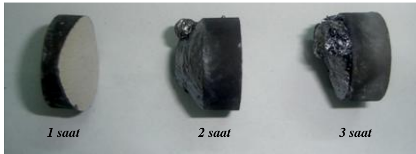
Şekil 3.7. \alpha - \text{Si}_3\text{N}_4 tozuyla hazırlanan ~1,9 cm çapındaki peletlerle 1200°C'de 1, 2 ve 3 saat süreyle gerçekleştirilen emdirme çalışmalarıyla üretilen karma yapılar
